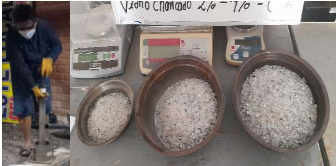
Figura 2. Chancado del vidrio reciclado
