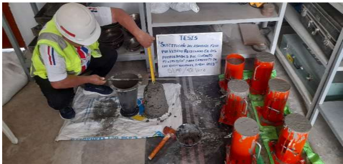
Figura 6. Ensayo del Slump
