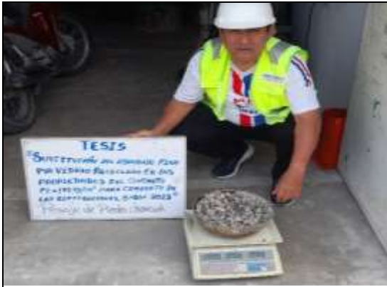
Figura 9: Pasaje de agregado grueso
