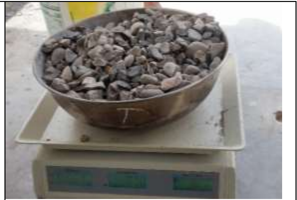
Figura 10: Pesaje de agregado grueso
