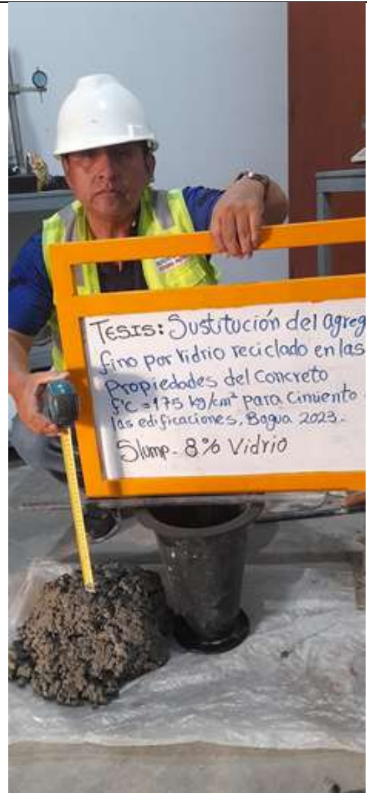
Figura 16: Medición del slump 8% vidrio
