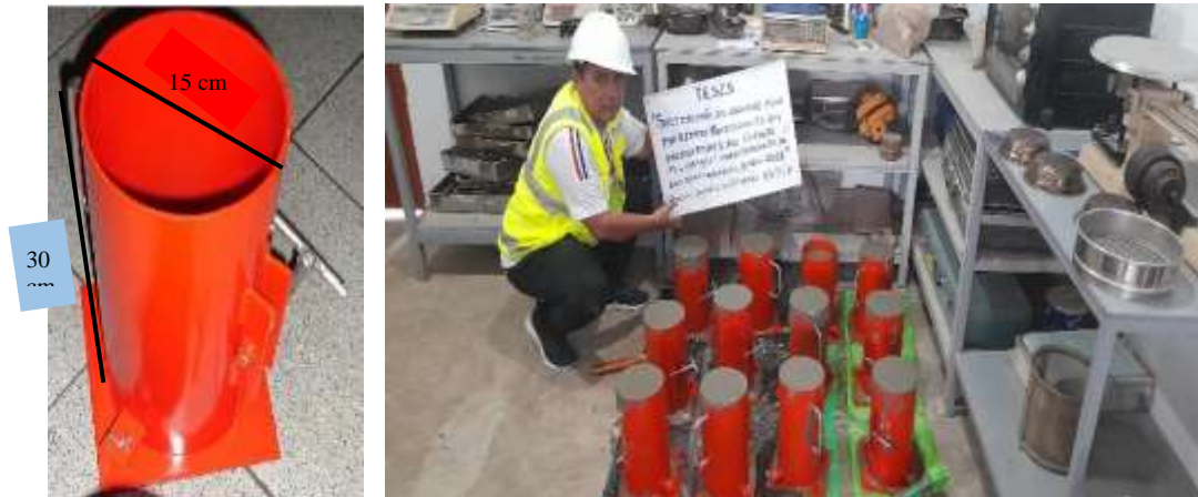
Figura 5. Molde de acero para elaborar la probeta de ensayo
