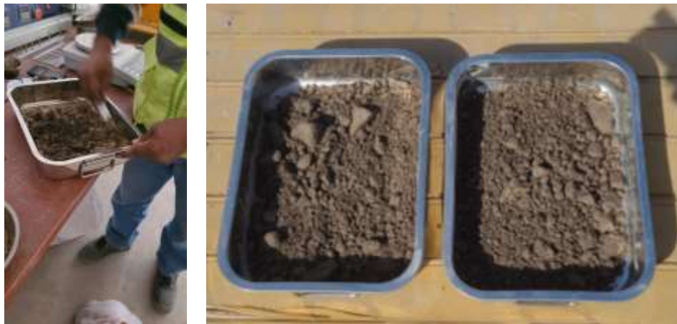
Figura 13. Muestras de base granular combinadas con emulsión asfáltica.
