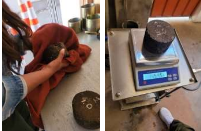
Figura 20. Pede de las briquetas superficialmente sumergido.
