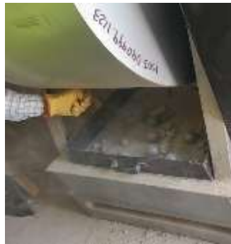
Figura 05. Ensayo de Abrasión (Maquina de los Ángeles), pasando por las mallas #1 1/2", 1", 3/4", 1/2" y 3/8".
