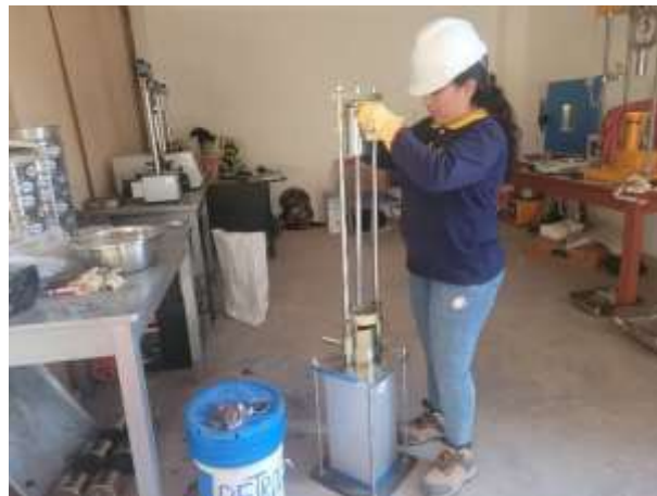
Figura 15. Compactado de la mezcla (75 golpes por lado) con el martillo.
