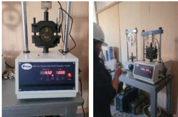
Figura 21. Ensayo Marshall de las muestras para hallar estabilidad y porcentaje de vacios.
