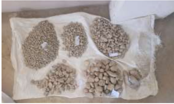
Figura 08. Ensayo de partículas fracturadas, chatas y alargadas, considerando las mallas 1", 3/4", 1/2" y 3/8".
