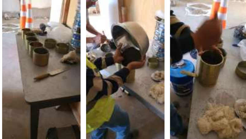
Figura 14. Vaciado de mezcla en los moldes para el compactado.
