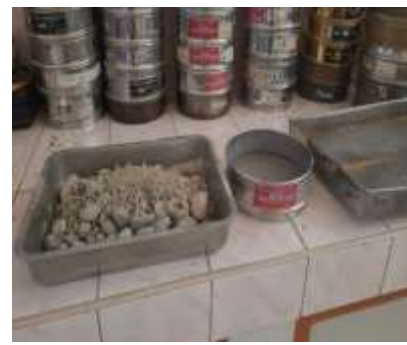
Figura 06. Después de pasar la abrasión, se pasa por la malla #12.
