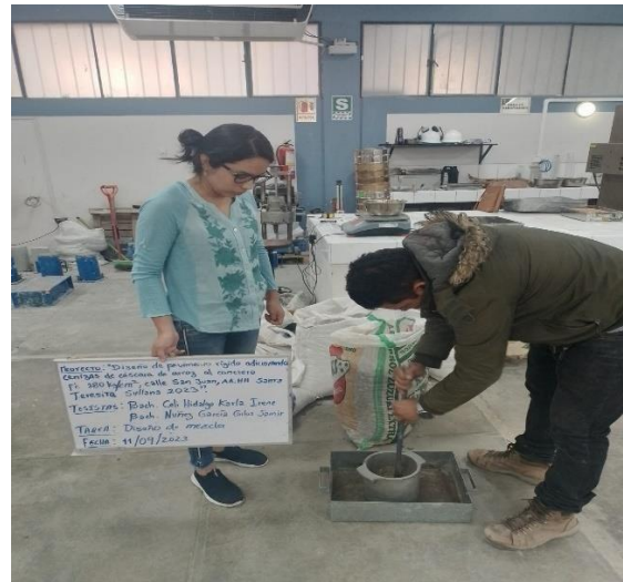
Figura 26: Cálculo de peso unitario compactado de agregado fino.
