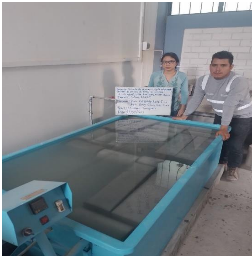
Figura 33: Curado de probetas y vigas.
