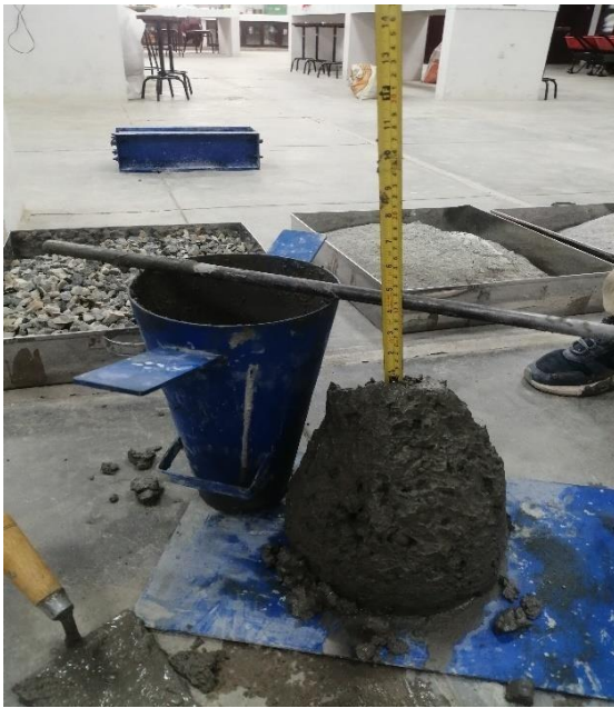
Figura 12. Slump de concreto patrón.
