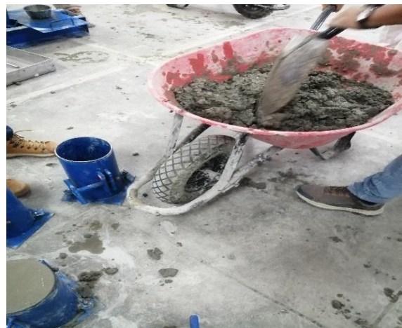
Figura 30: Elaboración de probetas cilíndricas.
