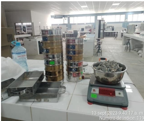
Figura 21: Ensayo de Granulometría.
