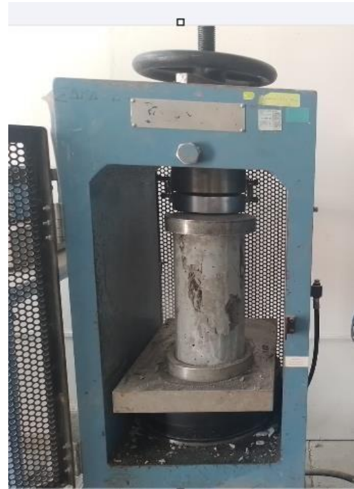
Figura 16. Rotura de probeta cilíndrica.
