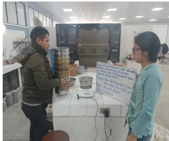
Figura 22: Tamizado de Agregado grueso.
