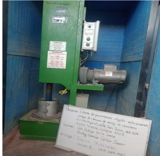
Figura 14: Proctor modificado método C.
