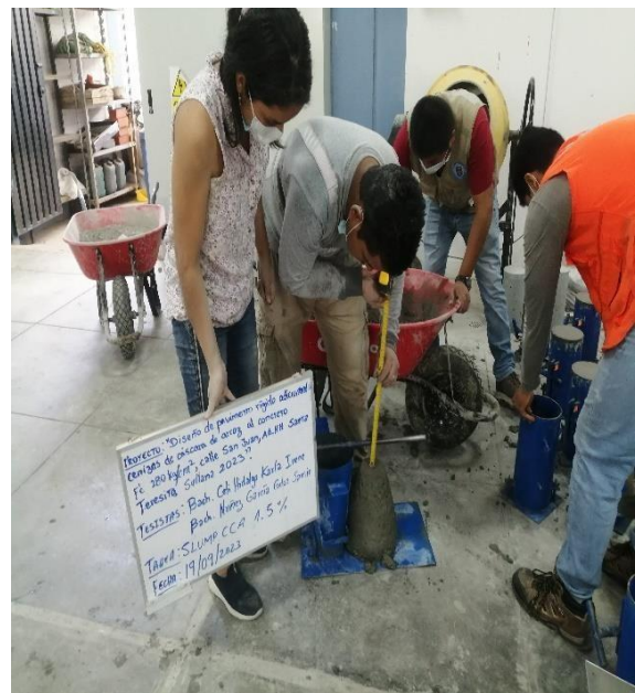
Figura 13. Slump de concreto con adición del 1.5 % de CCA.
