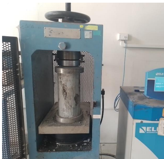
Figura 35. Rotura de probeta cilíndrica.
