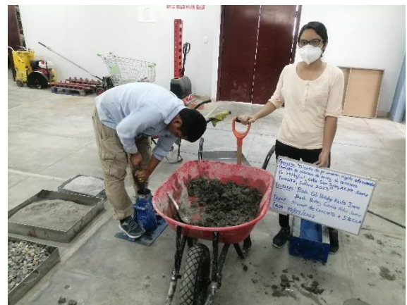
Figura 28: Cálculo de slump de concreto con adición del 5% de CCA.
