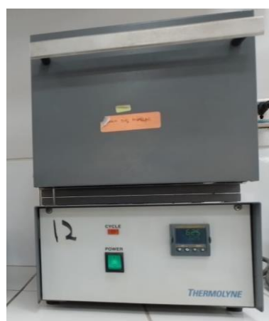
Figura 7. Horno para calcinación de cáscara de arroz.
