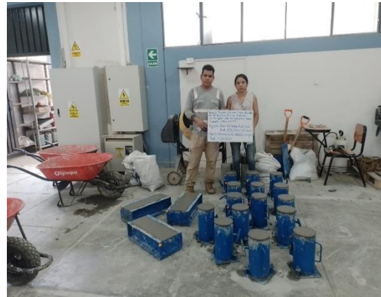
Figura 32: Elaboración de probetas cilíndricas y vigas.
