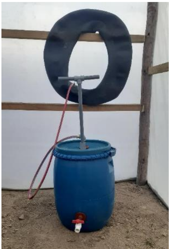
Foto N° 07: Biodigestor con gasómetro
