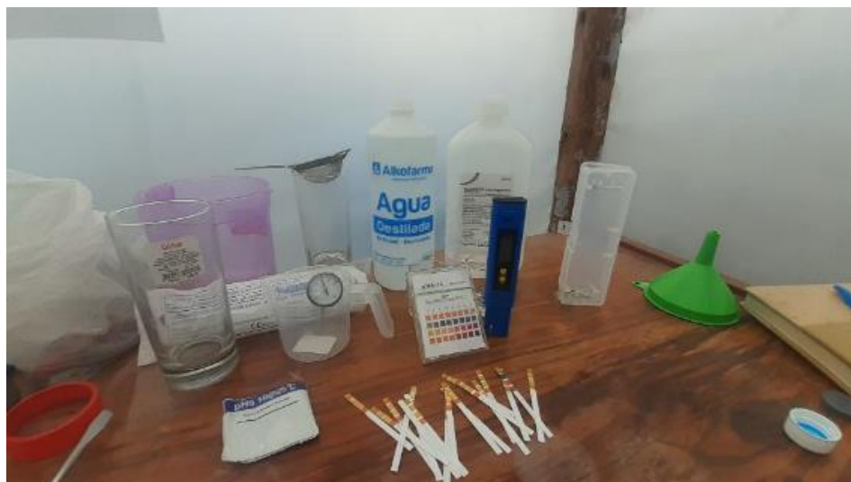
Foto N° 15: Control diario de temperatura y pH
