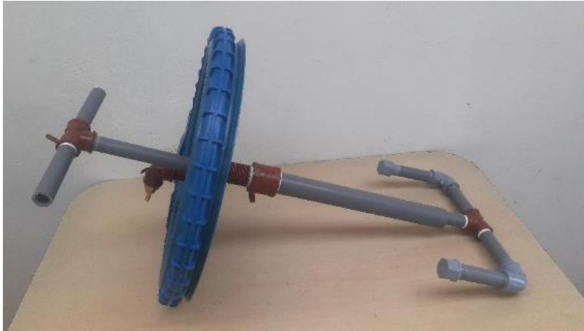
Foto N° 08: Detalle de tapa y paletas de agitación de los biodigestores
