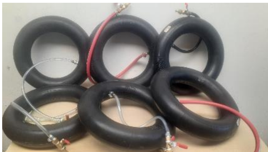
Foto N° 22: Gasómetros pequeños (cámaras de carretilla) para almacenamiento, traslado y evaluación del biogás.
