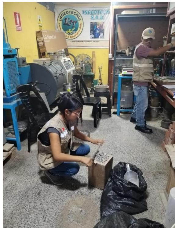
**FOTOGRAFÍA N° 03 y 04:** Se determinó el peso unitario suelto y compactado de agregado fino y grueso.
