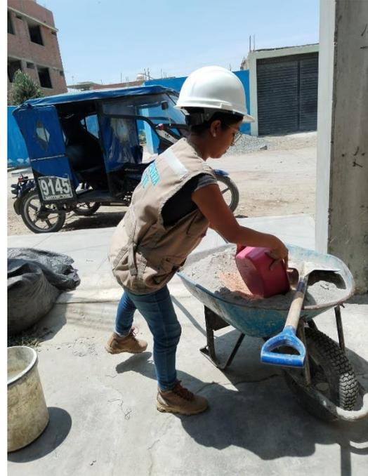
**FOTOGRAFÍA N° 19:** Proceso de mezclado a mano en carretilla de la mezcla patrón adicionando 0.75% de aserrín.
