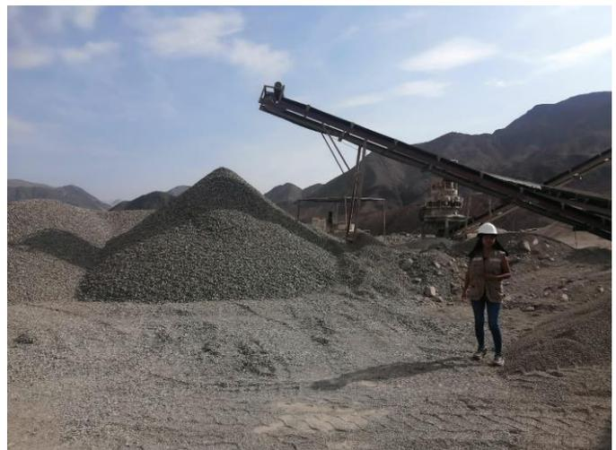
**FOTOGRAFÍA N° 04:** Se observa el acopio de agregado fino en la cantera.
