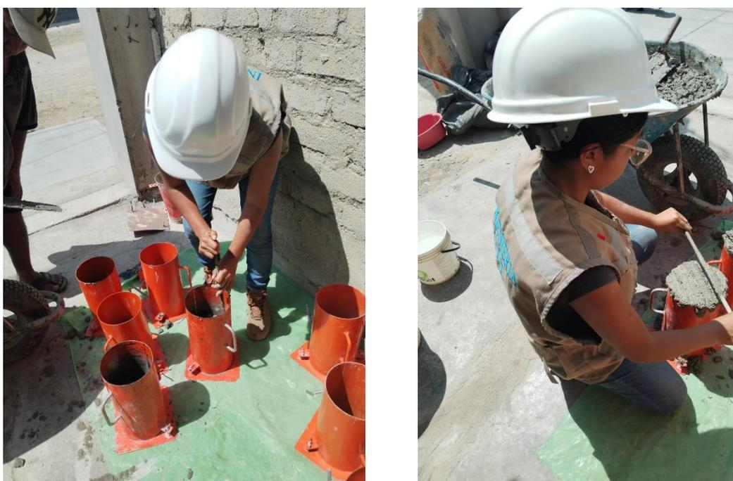
**FOTOGRAFÍA N° 25 y 26:** Desmoldado y tomas de peso de probetas de mezcla patrón adicionado 0.75% de aserrín.
