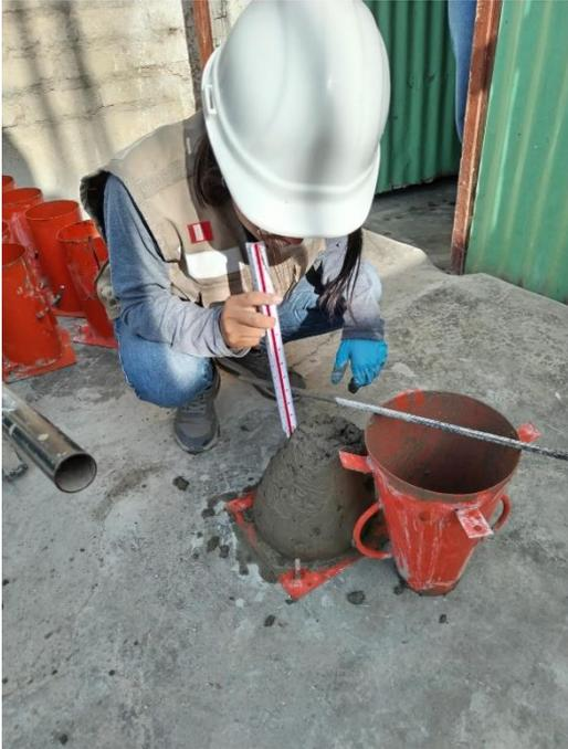
**FOTOGRAFÍA N° 30 y 31:** Elaboración de probetas de concreto adicionando 3.00% de aserrín.
