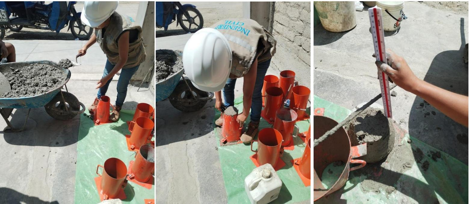
**FOTOGRAFÍA N° 23 y 24:** Vaciado de concreto adicionado 0.75% de aserrín en
