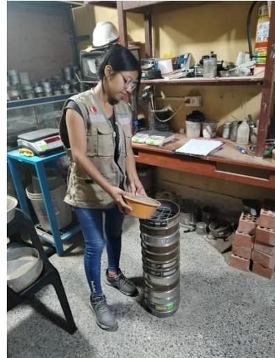
**FOTOGRAFÍA N° 09 y 10:** Se realizó el pesado de los agregados para el ensayo de granulometría.
