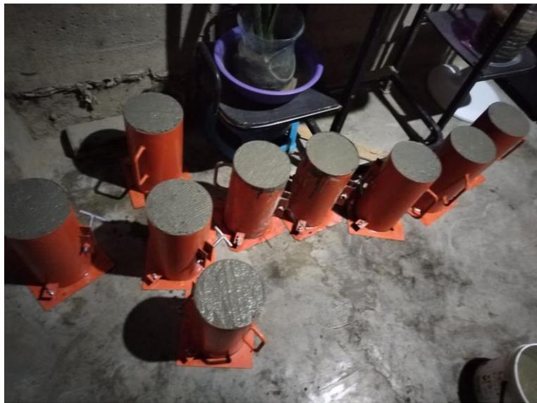
**FOTOGRAFÍA N° 12, 13 y 14:** Desmoldado de probetas y tomas de peso.
