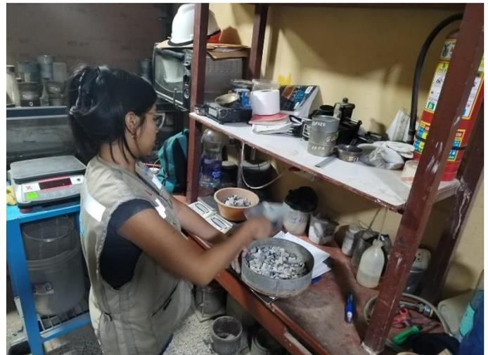
**FOTOGRAFÍA N° 11 y 12:** Los agregados fueron llevados al horno para luego ser pesados y obtener sus pesos específicos secos.
