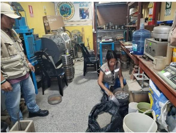
**FOTOGRAFÍA N° 07 y 08:** Se realizó el respectivo procedimiento/tamizado para el ensayo de granulometría de los agregados.
