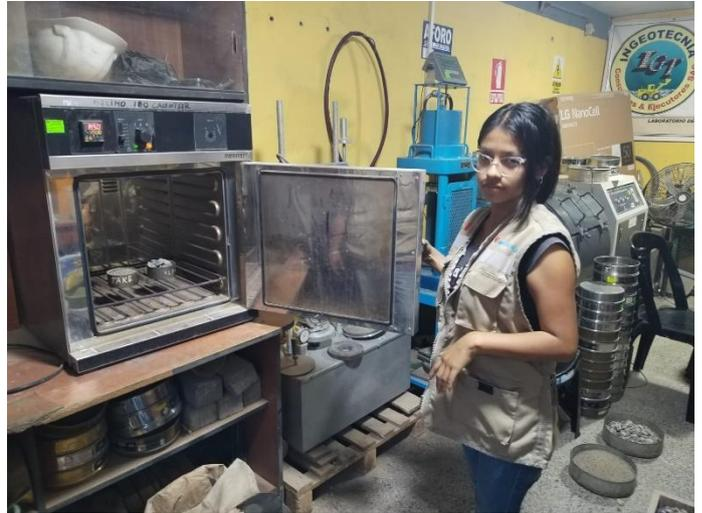
**FOTOGRAFÍA N° 13:** Se realizó el pesado de los agregados para el ensayo de granulometría.
