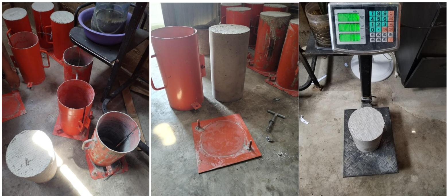
**FOTOGRAFÍA N° 15 y 16:** Proceso de curado de concreto en los moldes.
