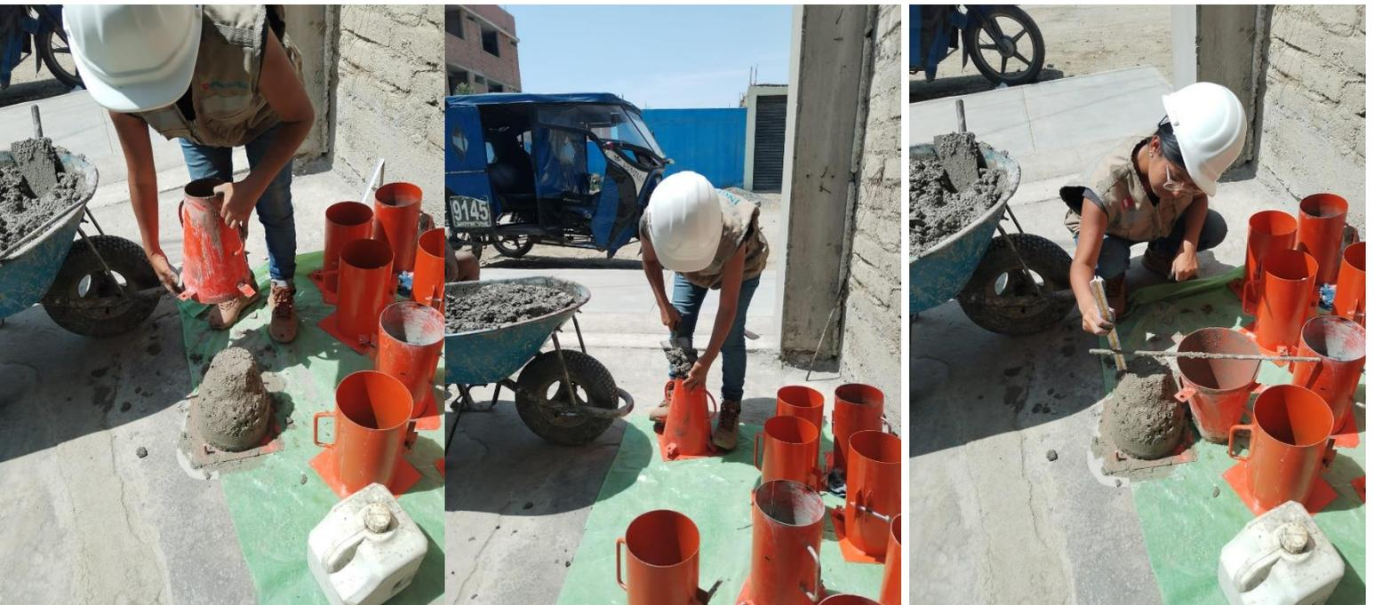
**FOTOGRAFÍA N° 09 y 10:** Se procede a elaborar las probetas, vaciando concreto en tres capas y siendo varilladas por 25 veces cada una, en cumplimiento a la normativa E060. Concreto armado. (12/10/2023)
