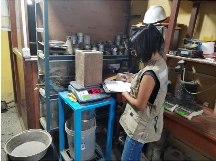
**FOTOGRAFÍA N° 05 y 06:** Se realizó el llenado de los agregados fino y grueso en los tamices para la granulometría de los materiales.
