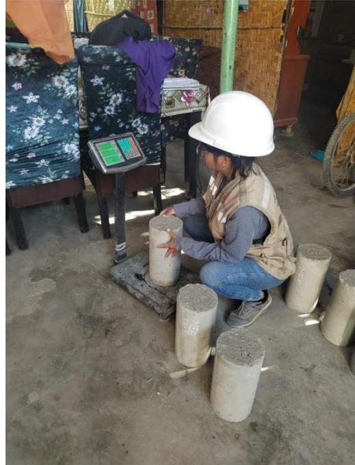
**FOTOGRAFÍA N° 27 y 28:** Pesado y preparación de mezcla de concreto patrón adicionado 3.00% de aserrín
