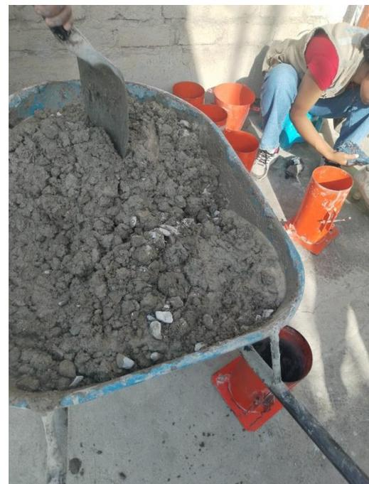
**FOTOGRAFÍA N° 29:** Prueba de consistencia de mezcla patrón adicionado 3.00% de aserrín.
