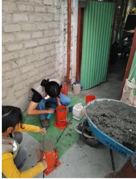
**FOTOGRAFÍA N° 11:** Fraguado de concreto en los moldes. (12/10/2023)
