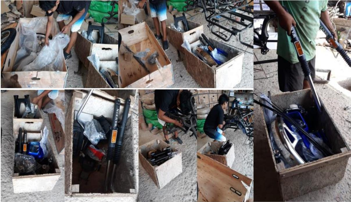
*Nota.* Luego que se estudie cada actividad que se realiza en el área de ensamblaje, se fabricó dos cajas con ruedas con la finalidad que, al momento de retirar los materiales, coloque cada trabajador en su caja destinada y se desplace con la caja al chasis instalado, de esta manera de trabajo, los ensambladores eliminaron el tiempo que dedicaban para traer cada material que era colocado en el suelo.
