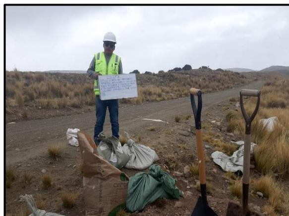
*Figura 14.* Extracciones las muestras en las tres calicatas.
