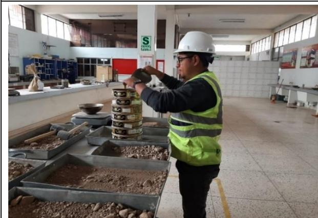
Figura 11: Análisis granulométrico.
