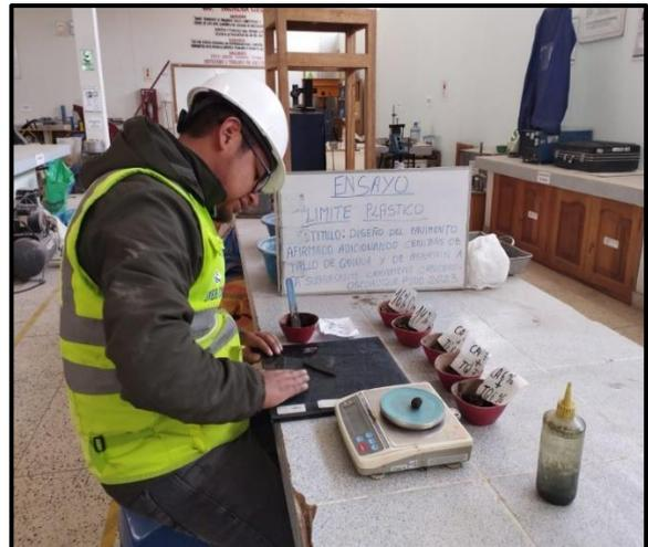
*Figura 30.* Ensayo del límite plástico.
