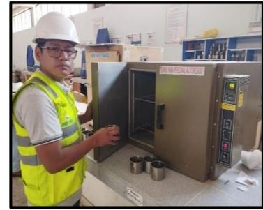
Figura 20. Ensayo del LL.
