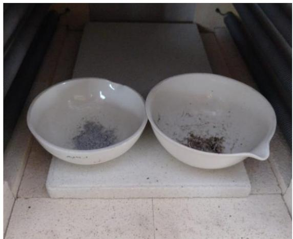
Figura 10: Ceniza resultante del proceso de calcinación.
