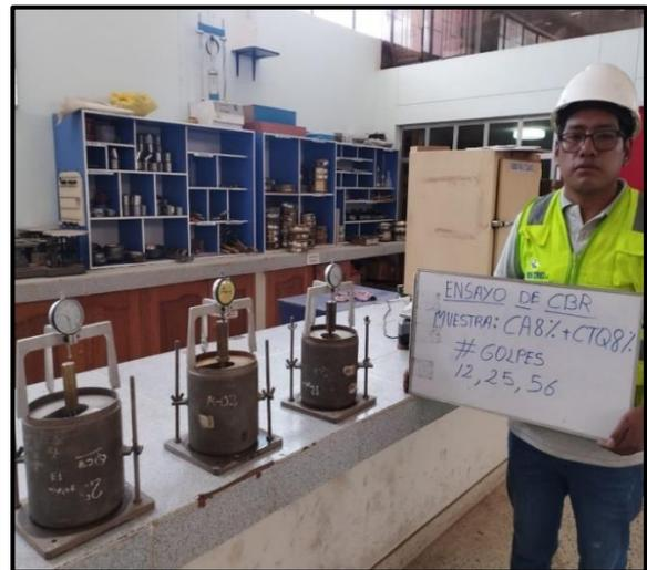
Figura 37. Moldes para el ensayo de CBR.
