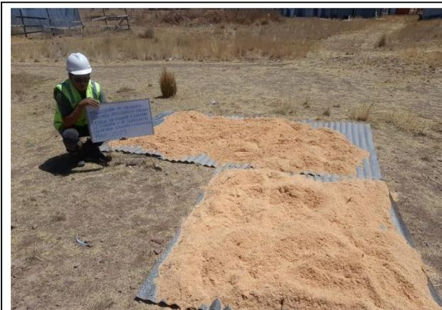
Figura 7: Material estabilizante ceniza de aserrín.
