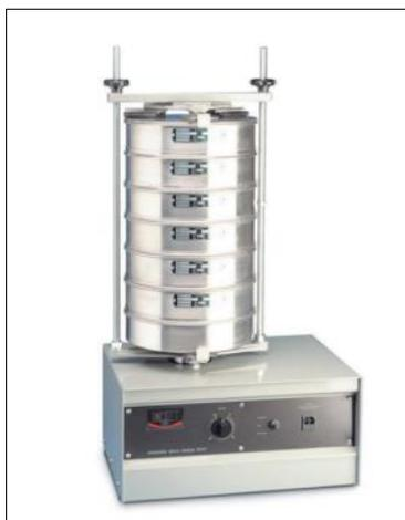
*Figura 6.* Juego de tamices sobre un equipo de vibración.
