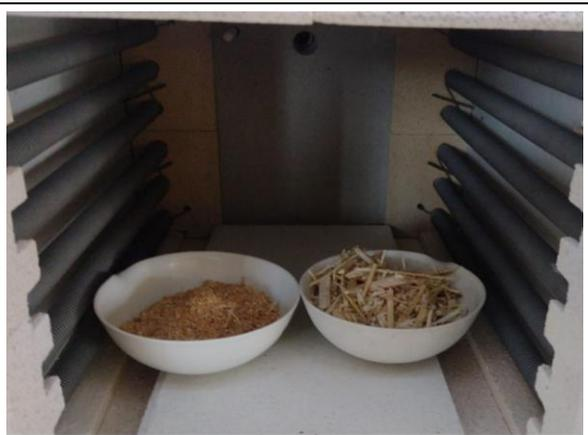
Figura 8: Aserrín y tallo de quinua antes del proceso de calcinación.
