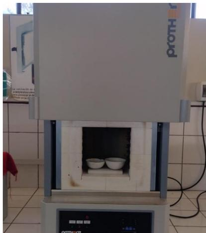
Figura 9: Proceso de calcinación en horno eléctrico.
