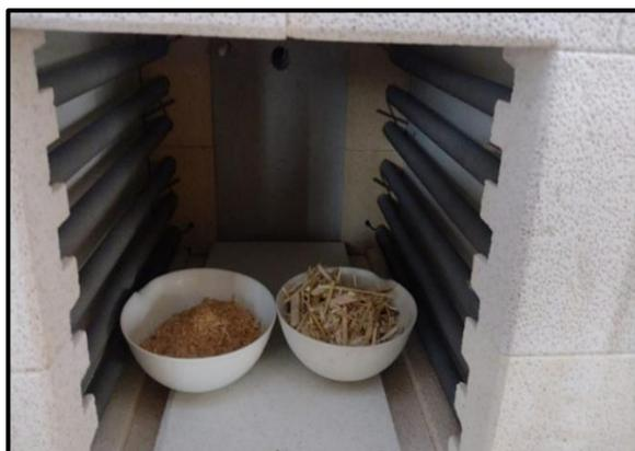
*Figura 15.* Incineración del tallo de quinua y de aserrín.
