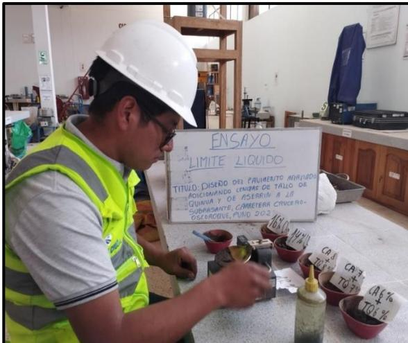
*Figura 29.* Ensayo del límite líquido con el equipo de Casagrande.
