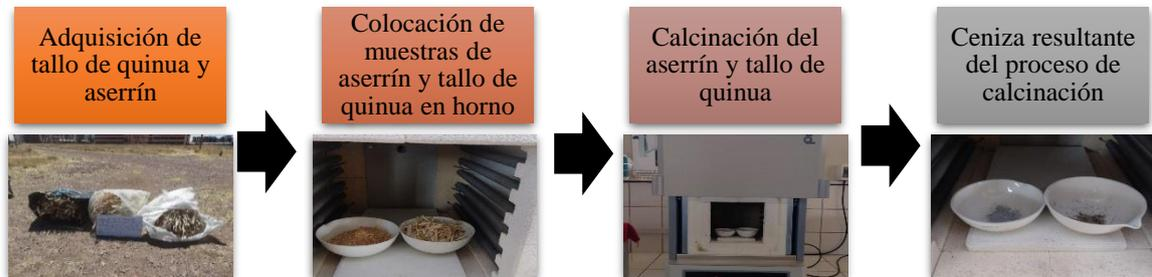
*Figura 28.* Proceso de calcinación del aserrín y tallo de quinua
