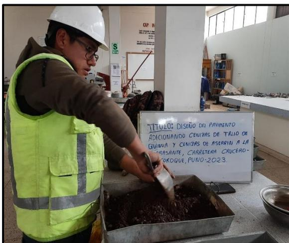
Figura 32. Preparación del material para el ensayo de Proctor.
