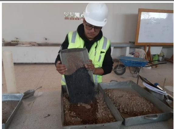
Figura 12: Ensayo del Proctor adicionando ceniza de aserrín
