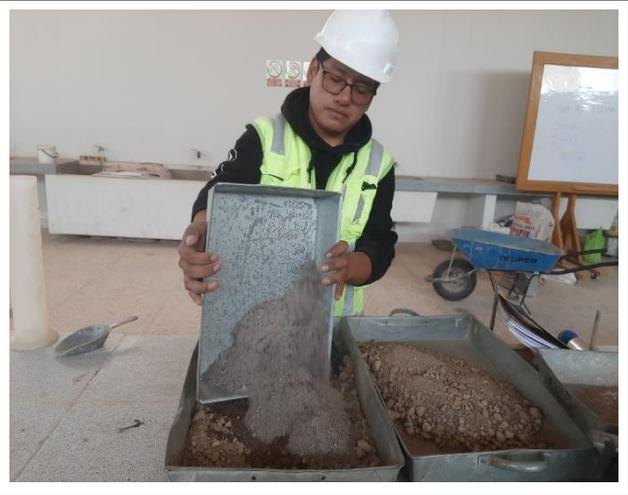
Figura 14: Ensayo de CBR adicionando ceniza de tallo de quinua
