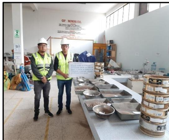
*Figura 17. Ensayo de granulometría por tamizado.*
