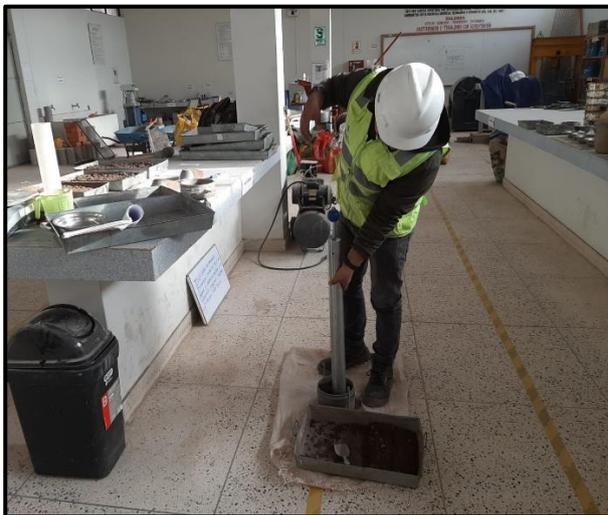
Figura 36. Compactado del espécimen en los moldes para el ensayo de CBR.
