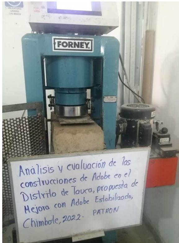
Ensayo de flexión, cemento 9%
