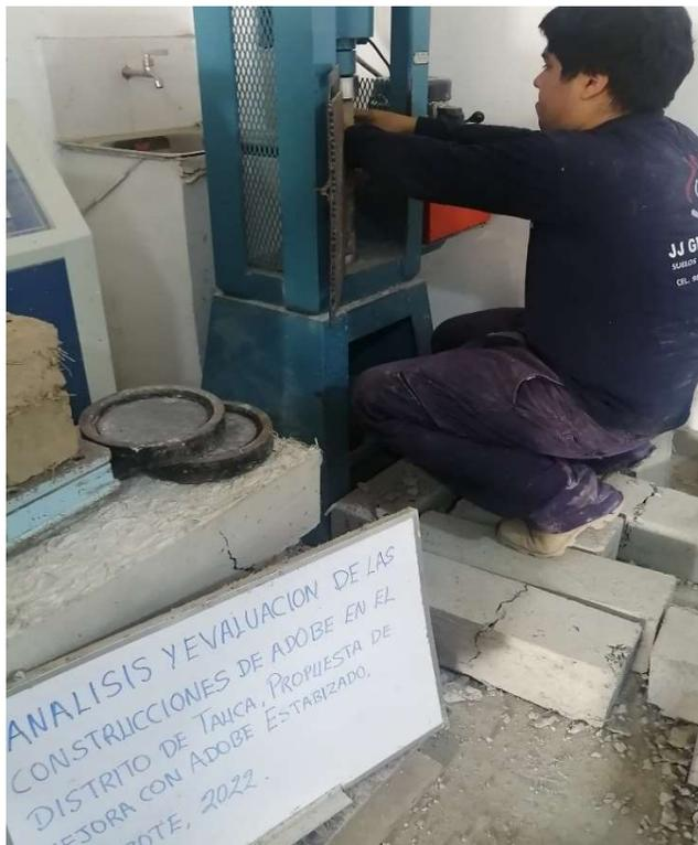
Ensayo de compresión, Patrón
