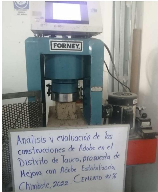
*Ensayo de compresión, Cemento 4%*
