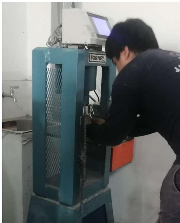
*Colocación de base para evitar deslizamiento de probeta*
