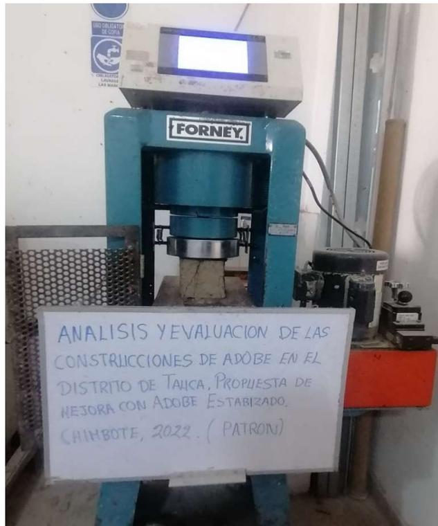
Ensayo de compresión, Cemento 9%
