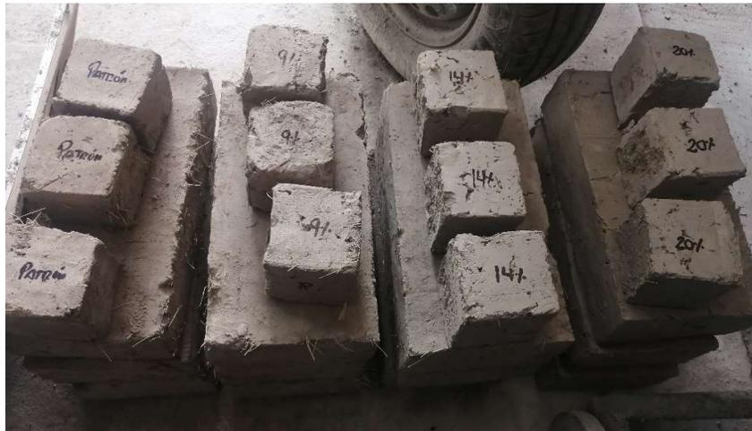
*Probetas cúbicas y ladrillos de adobe*
