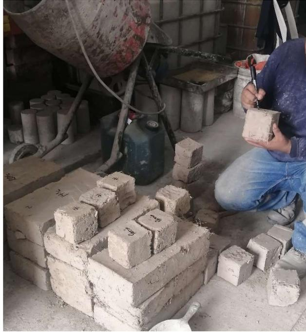
*Unidades de albañilería de adobe (Probetas cúbicas y rectangulares)*
