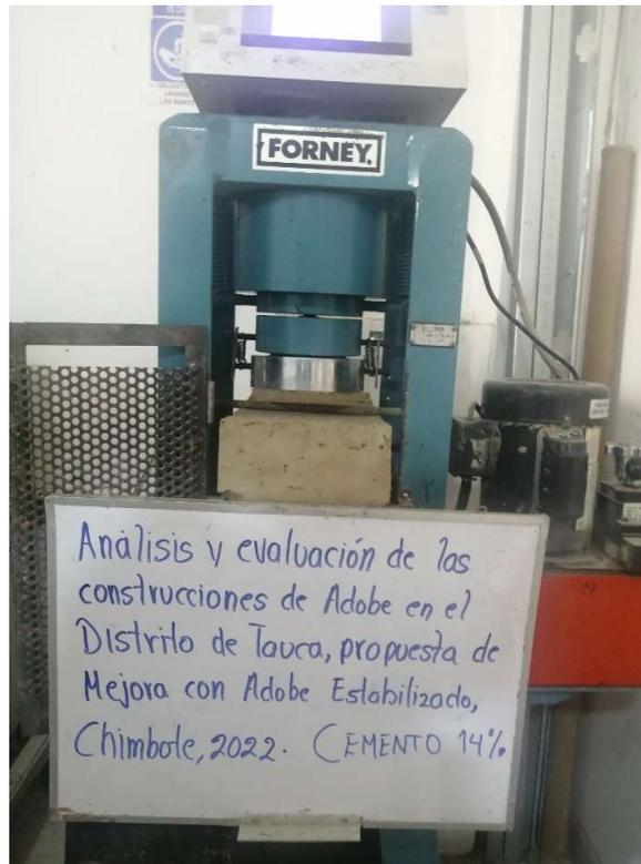
Ensayo de flexión, cemento 20%
