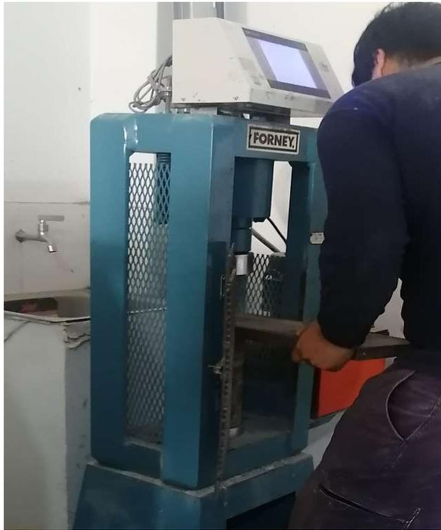
*Colocación de probeta cubica*
