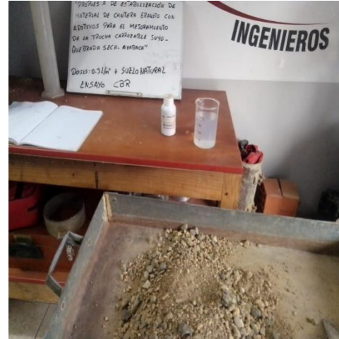
Fotografía 06: Adición de 0.3 L/m 3 de aceite sulfonado en el suelo natural.
