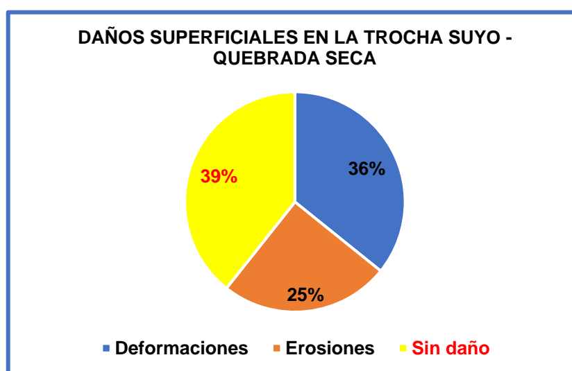
Figura 17: Porcentaje de daños presentes en la trocha carrozable Suyo - Quebrada Seca (elaboración propia)
