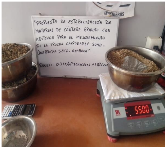
Fotografía 07: Adición de 0.3 L/m 3 de aceite sulfonado + 1.5% cemento a la muestra natural
