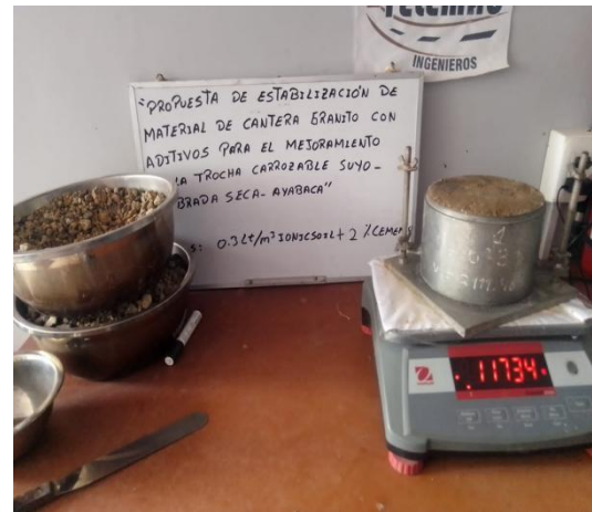
Fotografía 08: Adición de 0.3 L/m 3 de aceite sulfonado + 2.0% cemento a la muestra natural
