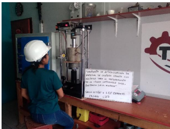
Fotografía 08 y 09: Ensayo California Bearing Ratio (CBR) de las muestras estabilizadas con aditivos.
