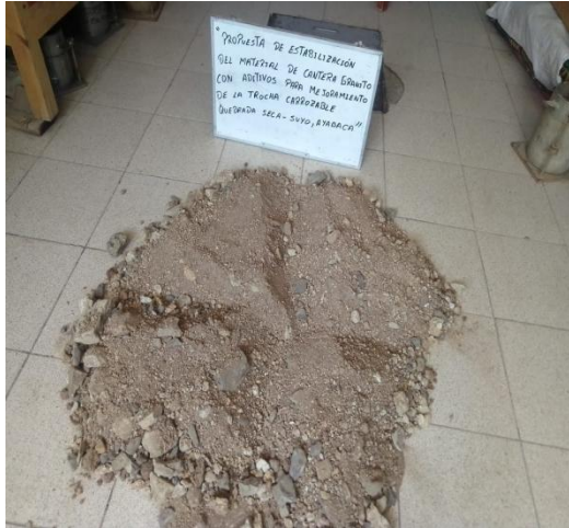
Fotografía 05: Cuarteo de material de cantera granito.
