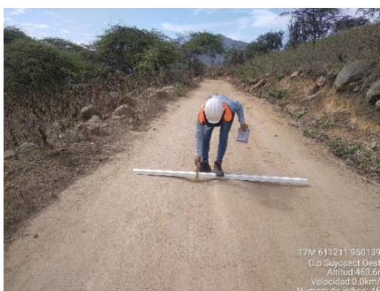
Figura 18: Deformación de gravedad 2, en Km 0+350 (elaboración propia)
