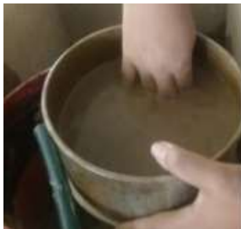
Figura 16. Lavado del material por el tamiz N°200.
