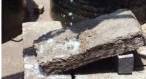
Figura 27. Ensayo de erosión acelerada.
