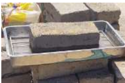
Figura 21. Ensayo de succión para las unidades de adobes.
