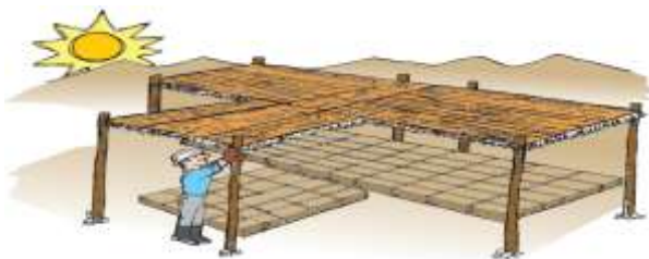
Figura 03. Secado y Colocación del adobe
