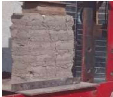
Figura 25. Ensayo de resistencia del murete a la compresión
