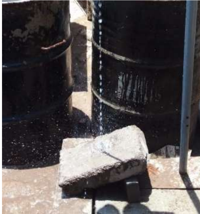
Ensayo de erosión acelerada.
