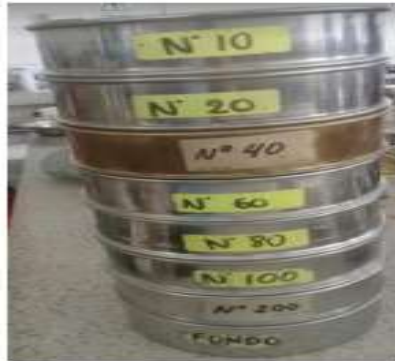
Figura 17. Ensayo de tamizado.
