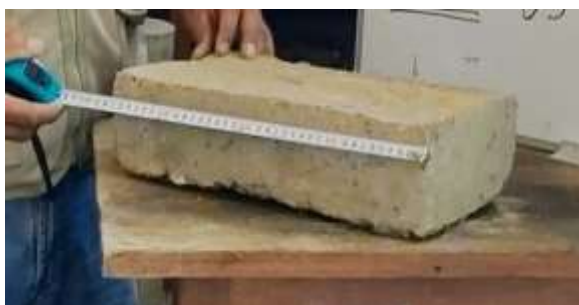
Figura 22. Medición de las dimensiones del adobe.
