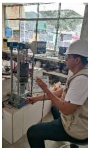
Figura 17. Ensayo de penetración CBR.
