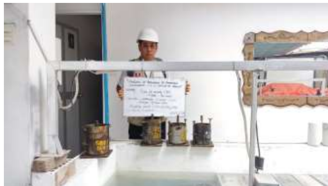
Figura 16. Hundimiento de moldes CBR.
