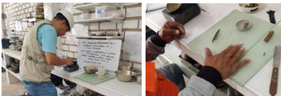
Figura 09. Procedimiento ensayo límites de consistencia.
