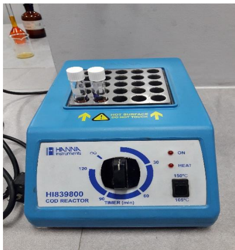
Figura 47: Reactor de tubos de ensayo para análisis de DQO
