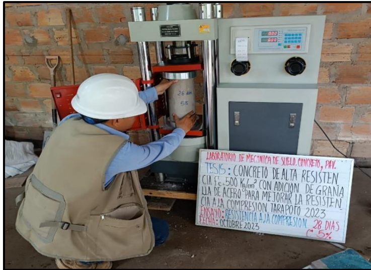
Fotografía 35: Ensayo de resistencia a la compresión 28 días- 10%
