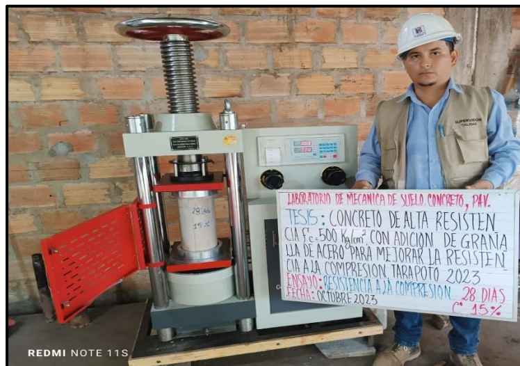
Fotografía 36: Ensayo de resistencia a la compresión 28 días- 15%
