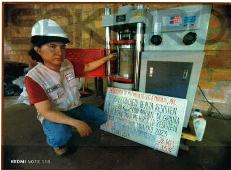
VISTA 04: SE OBSERVA ENSAYO DE RESISTENCIA A LA COMPRESIÓN DE ESPECÍMENES DE CONCRETO (ROTURA DE PROBETAS DE CONCRETO CON ADICIÓN 15%)
