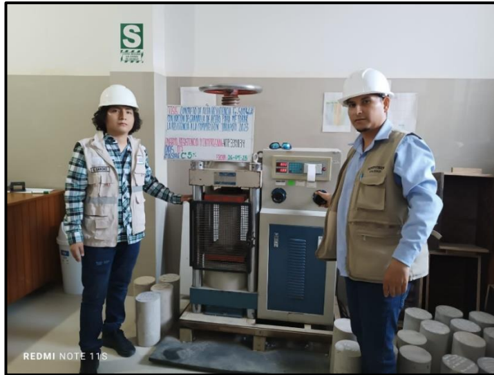
Fotografía 29: Ensayo de resistencia a la compresión 14 días- C° patrón
