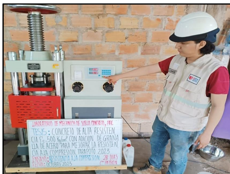
Fotografía 33: Ensayo de resistencia a la compresión 28 días- C° patrón
