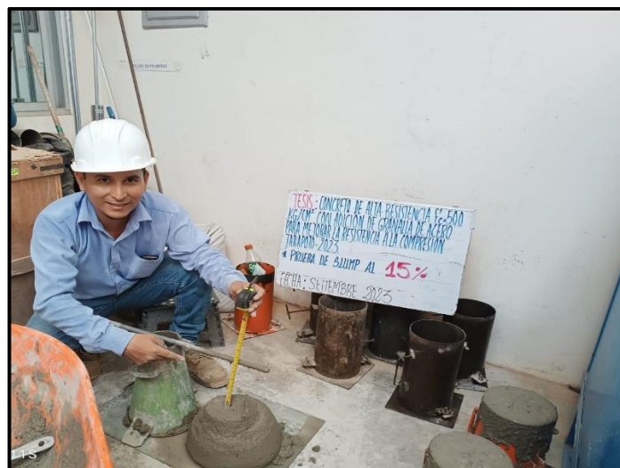
Fotografía 21: Prueba Slump con adición del 15% de aditivo
