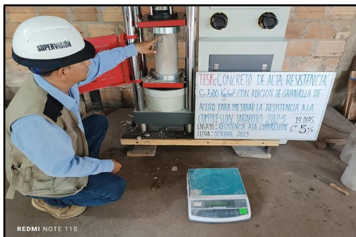
Fotografía 30: Ensayo de resistencia a la compresión 14 días- 5%
