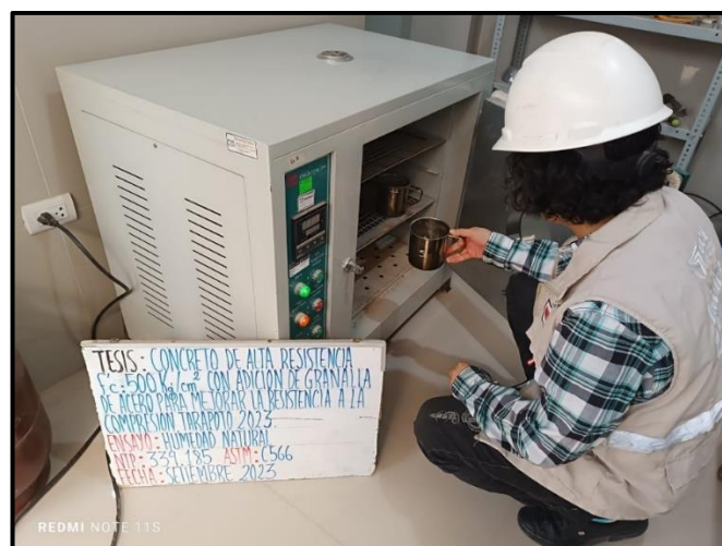
Fotografía 03: Ensayo de Contenido de Humedad
