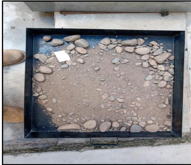
Fotografía 05: Lavado de agregado - Malla 200
