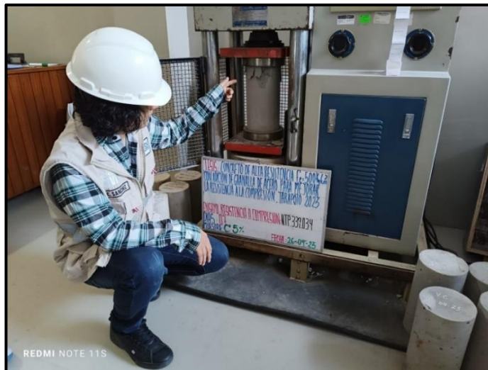
Fotografía 27: Ensayo de resistencia a la compresión 7 días – 10%
