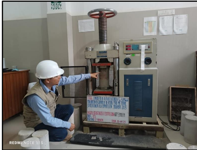
Fotografía 26: Ensayo de resistencia a la compresión 7 días – 5%
