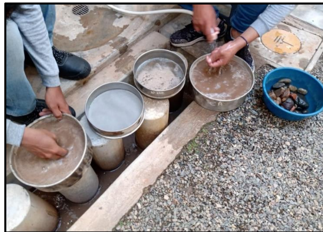
Fotografía 06: Tamizado de agregado (hormigón) – Granulometría
