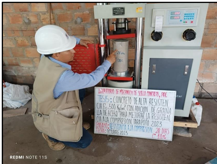
Fotografía 36: Ensayo de resistencia a la compresión 28 días- 15%
