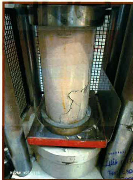
VISTA 01: SE OBSERVA ENSAYO DE RESISTENCIA A LA COMPRESIÓN DE ESPECÍMENES DE CONCRETO (ROTURA DE PROBETAS DE CONCRETO PATRÓN)
