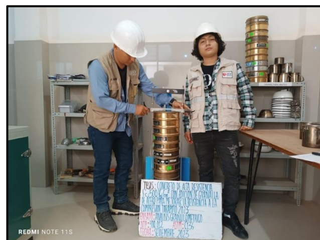
Fotografía 06: Tamizado de agregado (hormigón) – Granulometría
