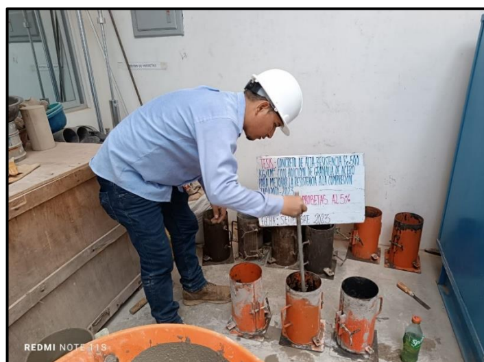
Fotografía 18: Elaboración de Probetas con adición del 5% de aditivo
