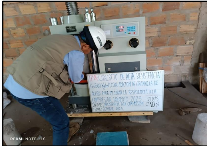
Fotografía 32: Ensayo de resistencia a la compresión 14 días- 15%
