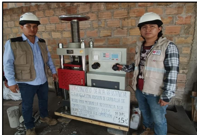
Fotografía 33: Ensayo de resistencia a la compresión 28 días- C° patrón
