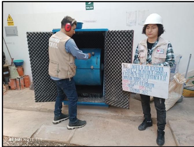
Fotografía 11: Elaboración de testigos de concreto
