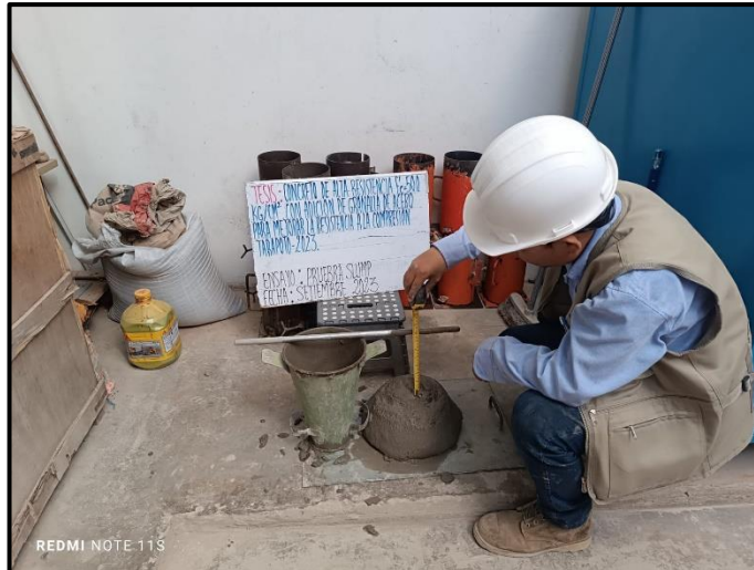
Fotografía 13: Prueba Slump – Concreto Patrón
