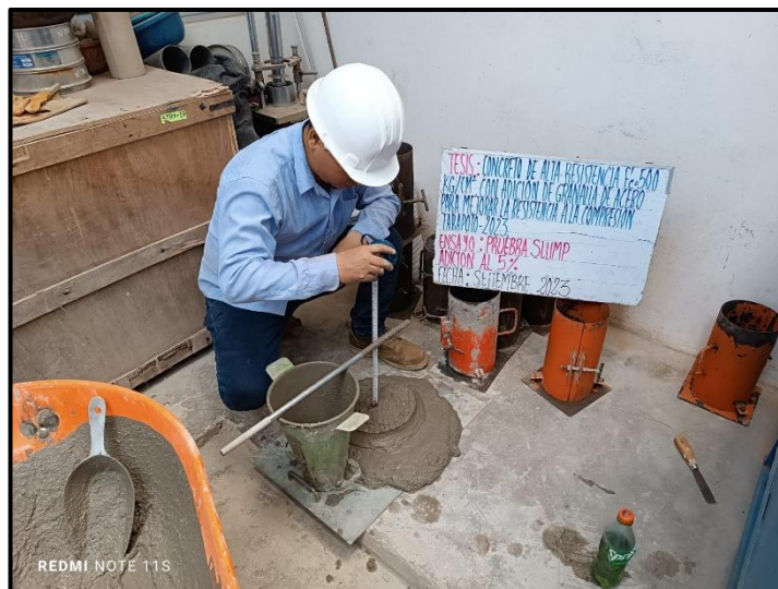
Fotografía 18: Elaboración de Probetas con adición del 5% de aditivo
