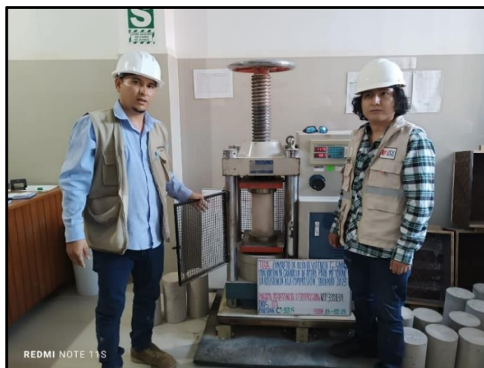
Fotografía 27: Ensayo de resistencia a la compresión 7 días – 10%
