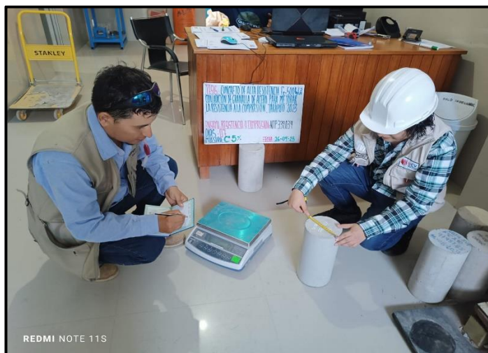
Fotografía 24: Registro de medida y peso de las probetas
