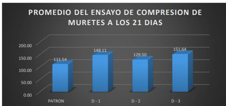
Figura 35 Grafico de resultados de la compresión en muretes de albañilería
