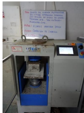
Figura 12 Medida de la resistencia a la compresión individual
