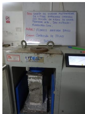
Figura 13 Medida de la resistencia a la compresión de pilas
