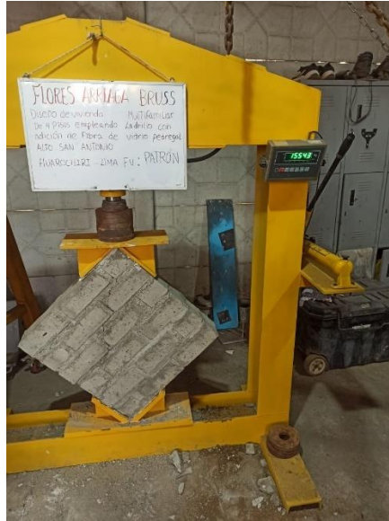
Figura 14 Medida de la resistencia a la compresión diagonal de muretes
