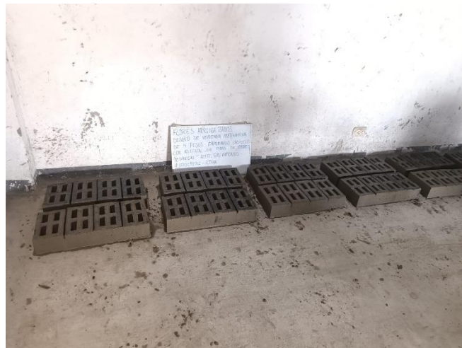
Figura 11 Curado del ladrillo con adición de fibra de vidrio
