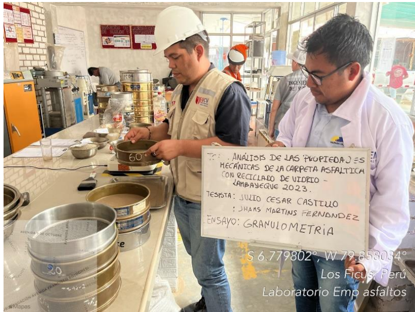
Tamizado de agregados para realizar la granulometría
