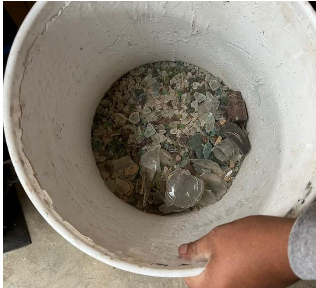
Molido de vidrio mediante la máquina de ángeles en distinta granulometría.
