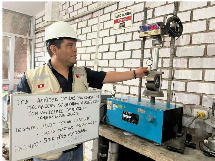
Prueba de Marshall de la muestra
