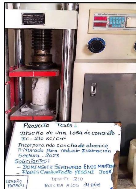
**Figura 08. Rotura de probetas**
