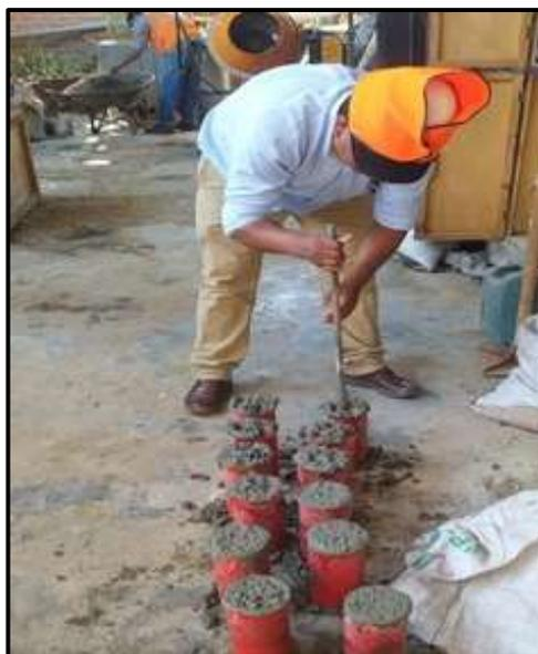
**Figura 07. Elaboración de Probetas**
