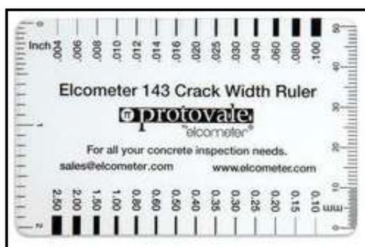
**Figura 11.** Tarjeta de comparación-Fisurómetro
