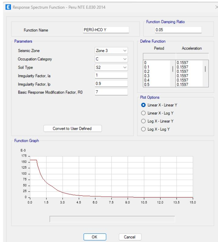
**Figura 16.** Definición del caso de carga en sismo X y Y
