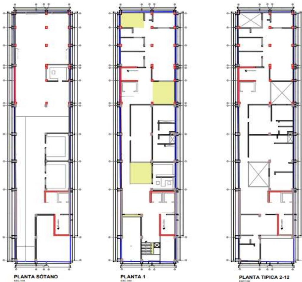
Figura 14: Estructuración del edificio de 12 niveles de concreto armado
