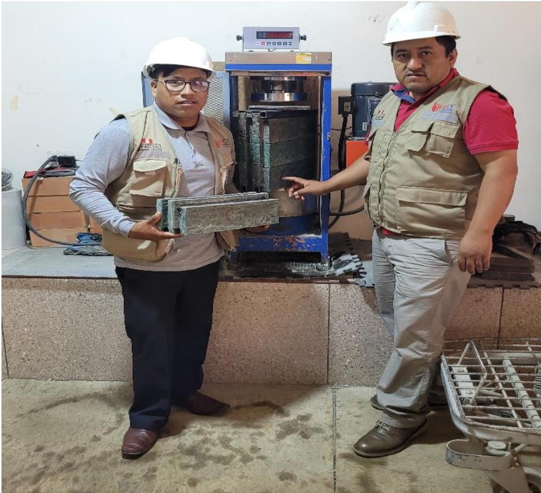
*Figura 26. Se observa la colocación de la pila en la máquina para someterlo a fuerzas de compresión y determinar su resistencia.*
