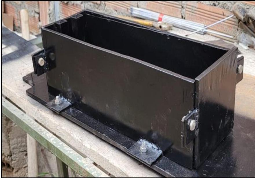
Figura 3. Ensamblado de un molde Ensamblado de molde, unión de sus cuatro piezas con pernos de 3/8"x1".
