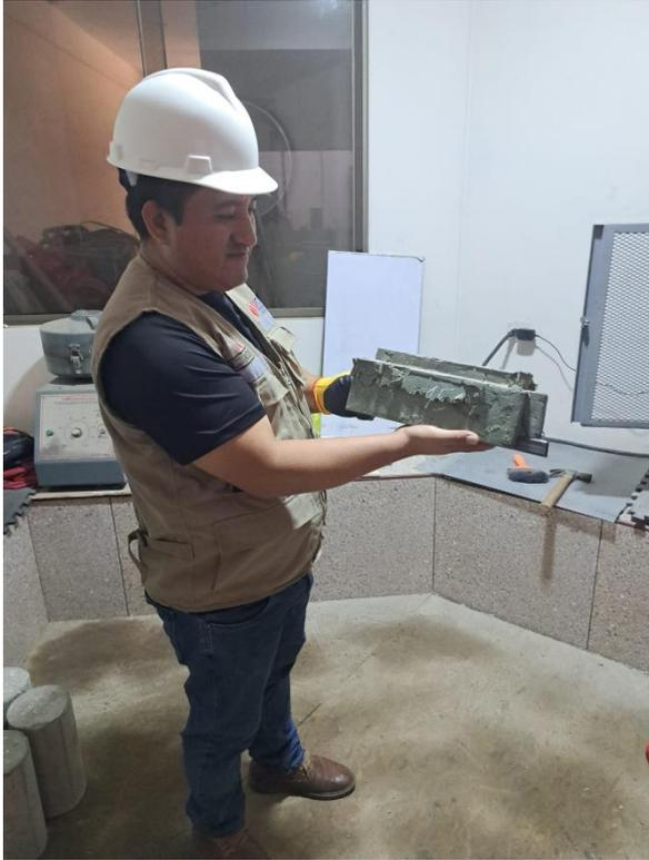
*Figura 18. El ladrillo de plástico reciclado ha fallado por las cargas de compresión impuestas por la máquina de ensayo.*
