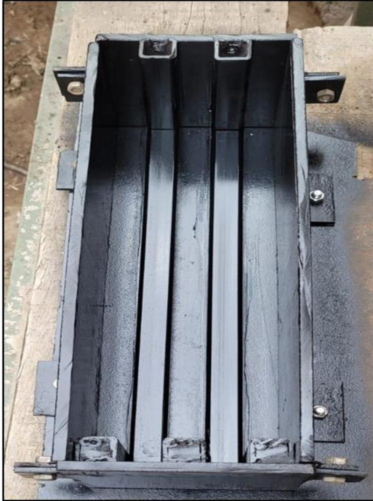
*Figura 2. Presentación interior de un molde donde se observa los perfiles*
