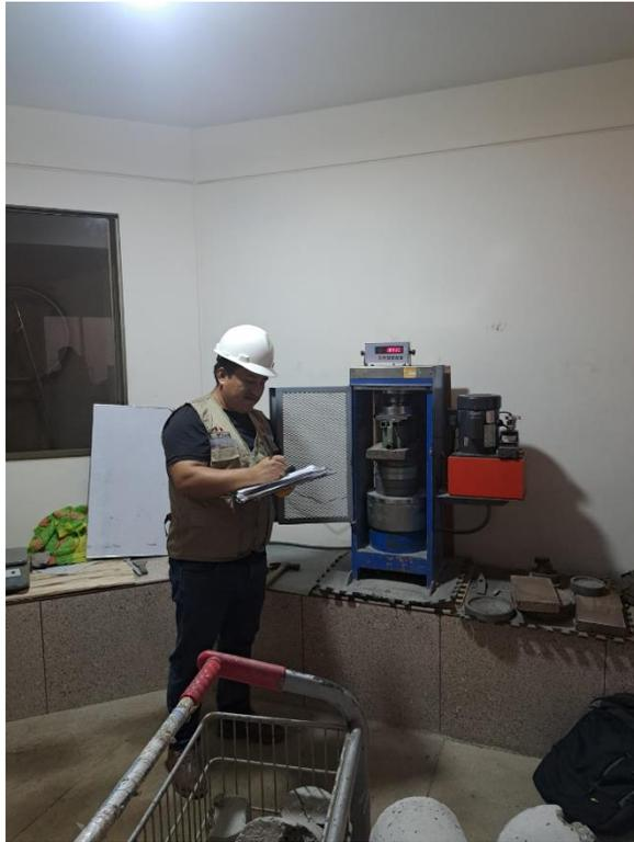
*Figura 16. Se ingresa al laboratorio los testigos para verificar la resistencia a la compresión de los ladrillos de plástico reciclado.*
