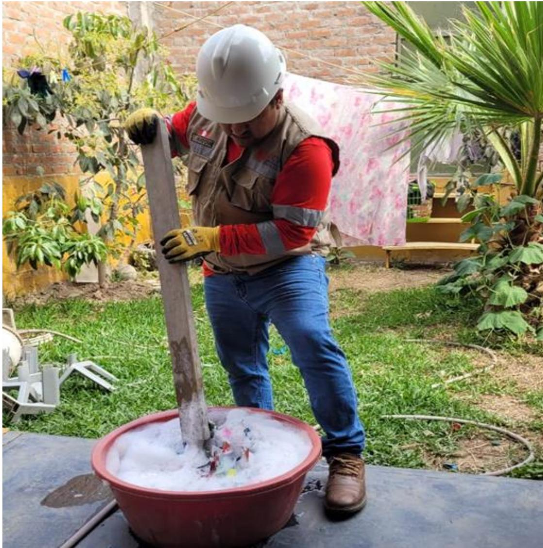
*Figura 8. Proceso de lavado con detergente del plástico ya triturado para eliminar grasas, aceites, con la finalidad de garantizar un óptimo masificado.*
