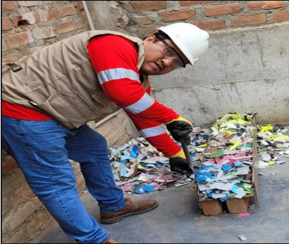
*Figura 7. Triturado de plástico reciclado de baja y alta densidad con una cortadora manual estacionaria.*
