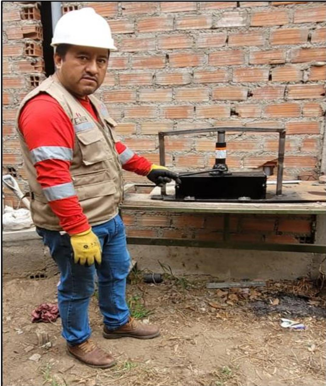
*Figura 9. Vaciado y prensado de la masa en el molde hasta el endurecimiento.*
