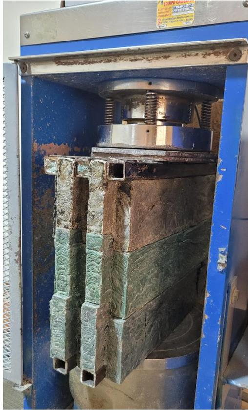
*Figura 27. Se Observa que la pila ha fallado debido a las fueras de compresión.*
