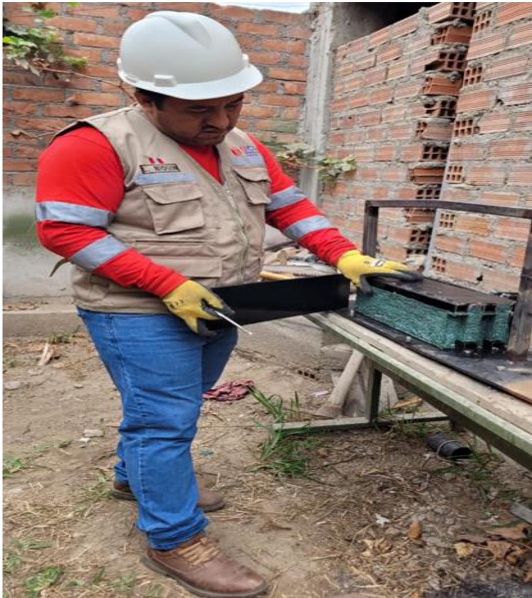
*Figura 10. Desempernado y desmolde de las piezas metálicas, se visualiza el prototipo de ladrillo de plástico ya endurecido.*
