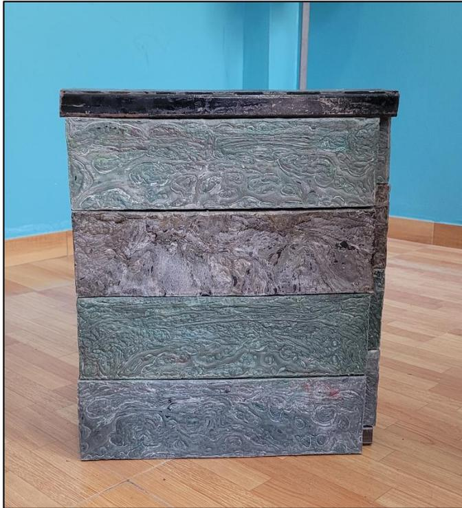
*Figura 25. Presentación final del murete de ladrillos de plástico reciclado, se envía al laboratorio para su respectiva prueba a la compresión.*
