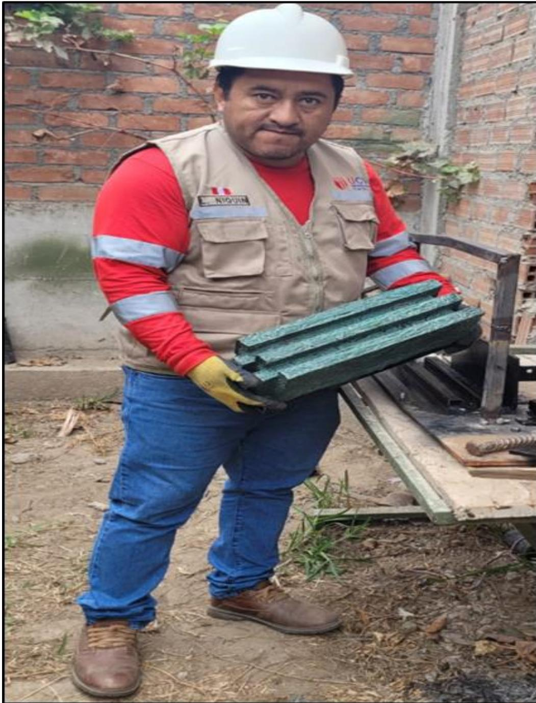
*Figura 11. Desmoldado del ladrillo de plástico reciclado.*
