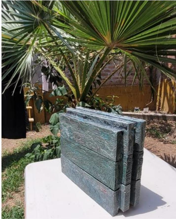
Figura 15: Presentación de una pila de tres ladrillos amarrados por dos juntas horizontales, se observa las dos juntas verticales expuestas.
