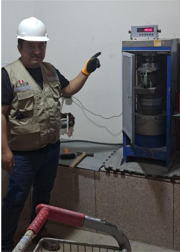
*Figura 17. Se visualiza la máxima carga que logra resistir el ladrillo en la máquina de ensayo.*
