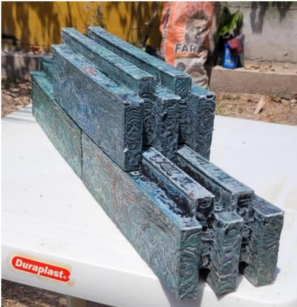
Figura 13. Vista de asentado de ladrillos traslapando las espigas y canales cumpliendo la función de juntas horizontales y verticales.
