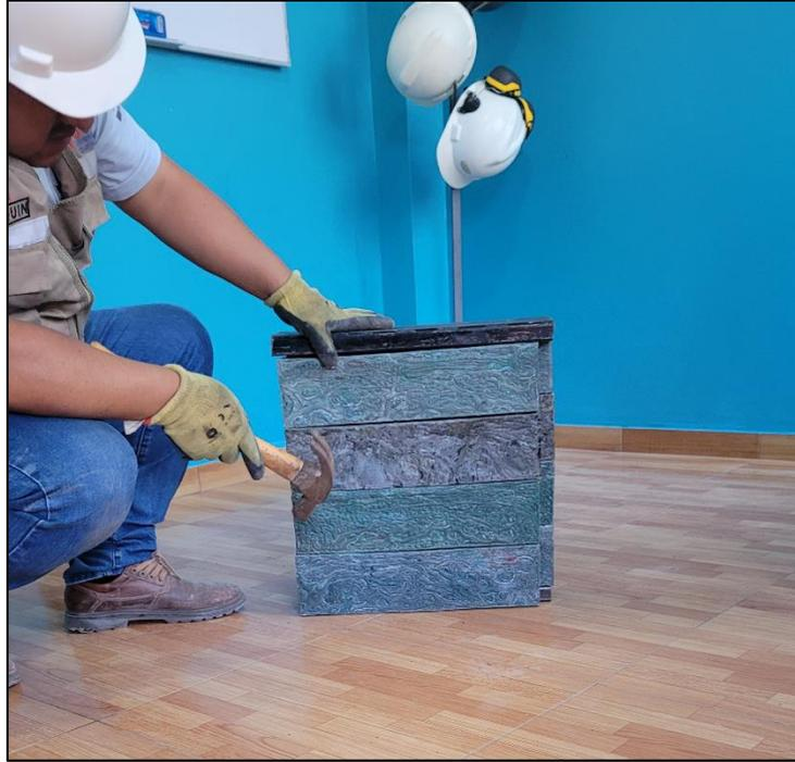
*Figura 24. Se colocan perfiles de 1"x1"x2.8mm en espigas superiores del ultimo ladrillo para una adecuada distribución de las cargas.*
