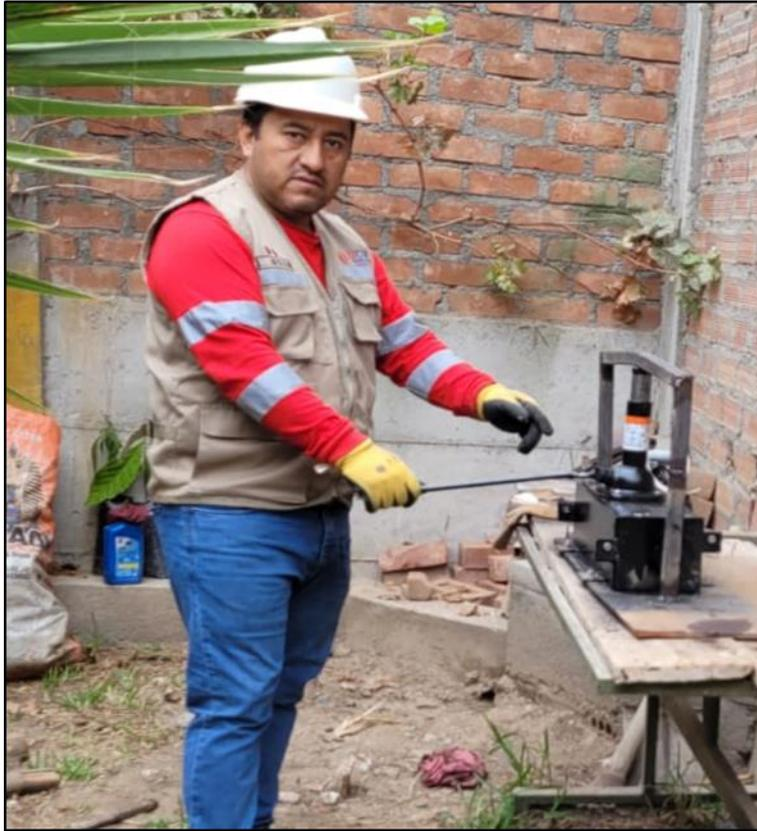
*Figura 4. Arco prensa para comprimir la masa dentro del molde hasta el enfriado y endurecimiento del espécimen.*
