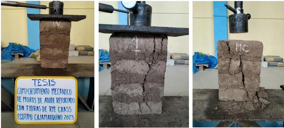
Foto 19, 20 y 21: Ensayo de pilas a compresión, fallas típicas en las pilas de adobe.
