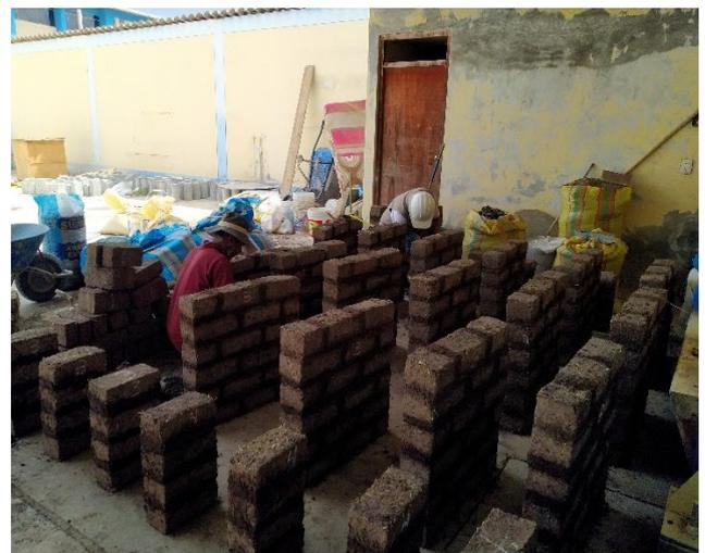
Foto 16: Traslado de unidades al laboratorio de la UNC para fabricación de muretes
