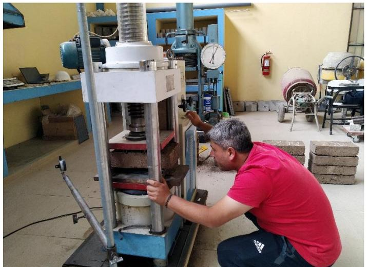
Foto 20: Prensa para ensayo a flexión
