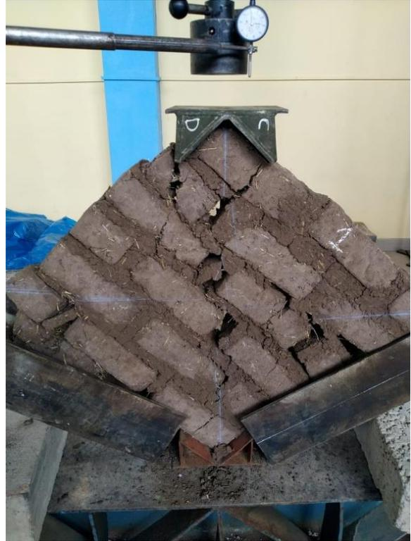
Foto 26: Falla típica en muros
