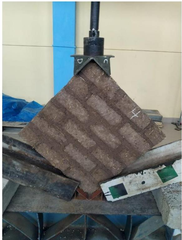
Foto 28: Ensayo de tracción indirecta
