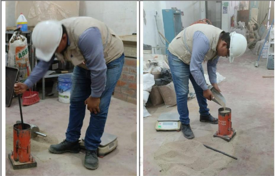
Fotos n° 13-14: En las imágenes podemos observar realización del ensayo de peso unitario de la arena zarandeada.
