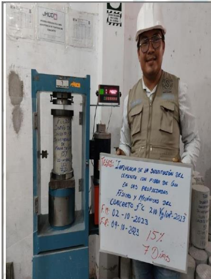
Fotos n° 25-26: En las imágenes podemos observar la resistencia a la compresión axial de los testigos de concreto
