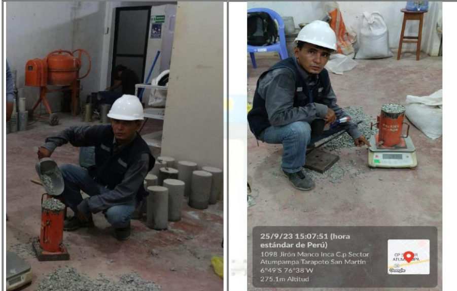
Fotos nº 13-14: En las imágenes podemos observar realización del ensayo de peso unitario de la grava.
