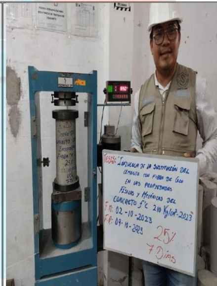
Fotos n° 25-26: En las imágenes podemos observar la resistencia a la compresión axial de los testigos de concreto
