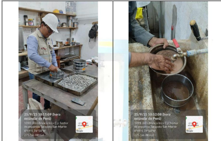
Fotos nº 09-10: En las imágenes se puede apreciar el ensayo de análisis granulométricos y lavado del agregado fino.
