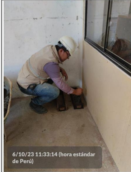
Fotos n° 23-24: En las imágenes podemos observar el moldeo de los bloques de concreto y asentamiento para el diseño de la mezcla.
