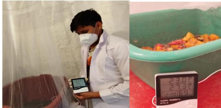
*Figura 15.* Medición de temperatura y humedad con el higrómetro.
