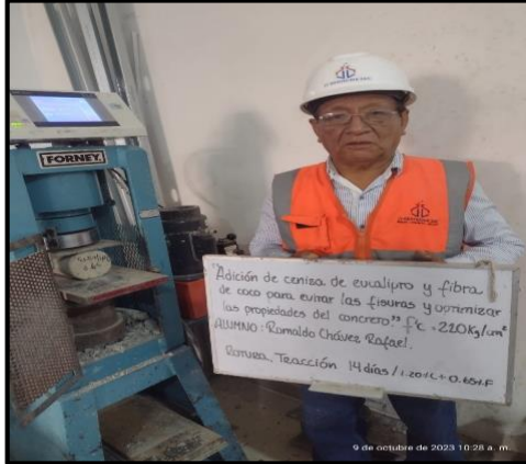
Fotografía 13. Ensayo de resistencia a tracción indirecta
