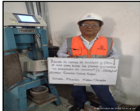
Fotografía 14. Ensayo de resistencia a flexión
