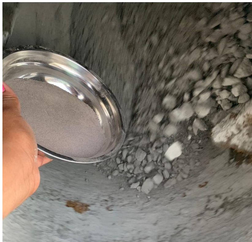
Figura 26. Ensayo de finura del polvo alga marina pasando por la malla N°100
