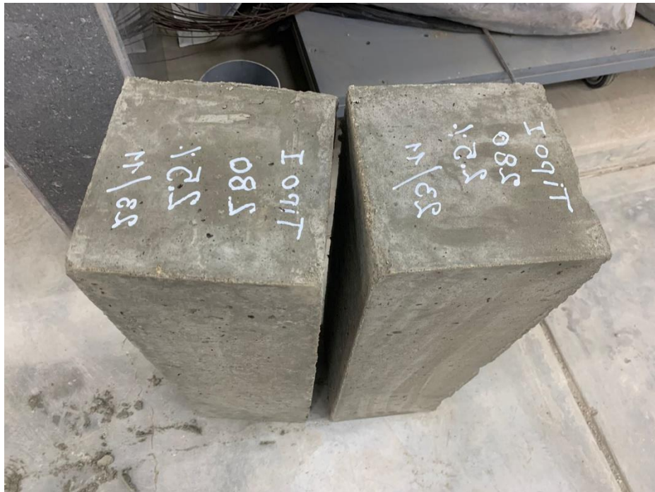
Figura 29. Vigas con los porcentajes de sustitución parcial al cemento
