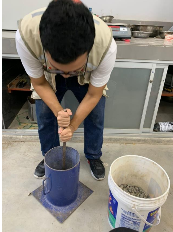
Figura 22. Ensayo de peso específico y unitario de agregado fino y grueso
