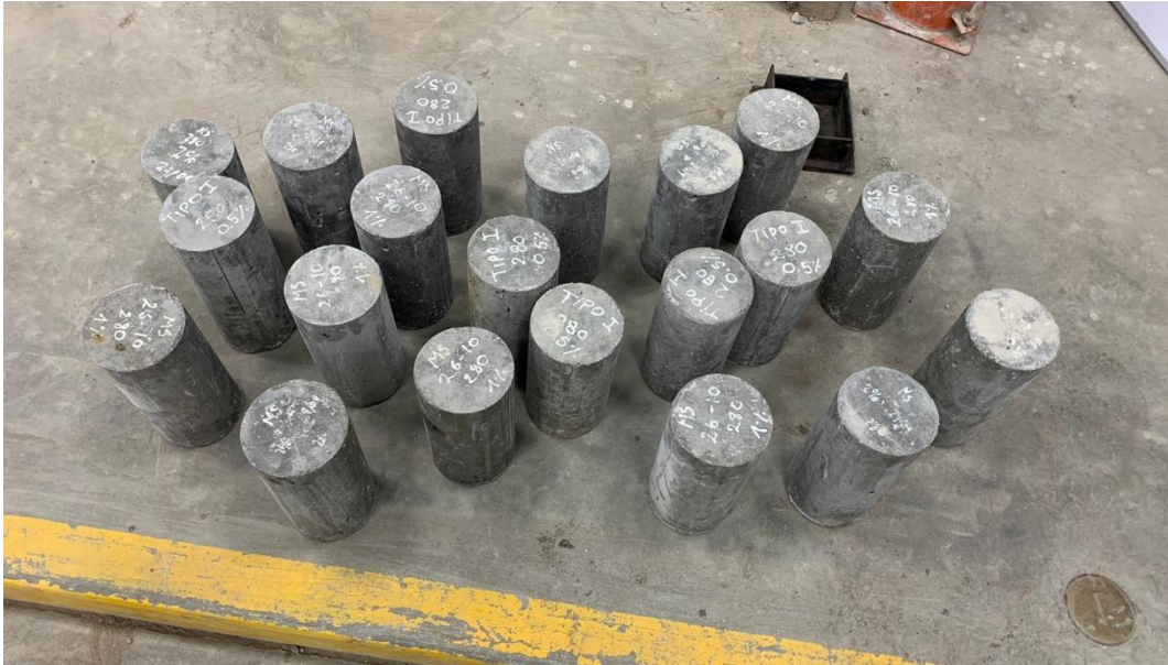
Figura 28. Probetas con los porcentajes de sustitución parcial al cemento
