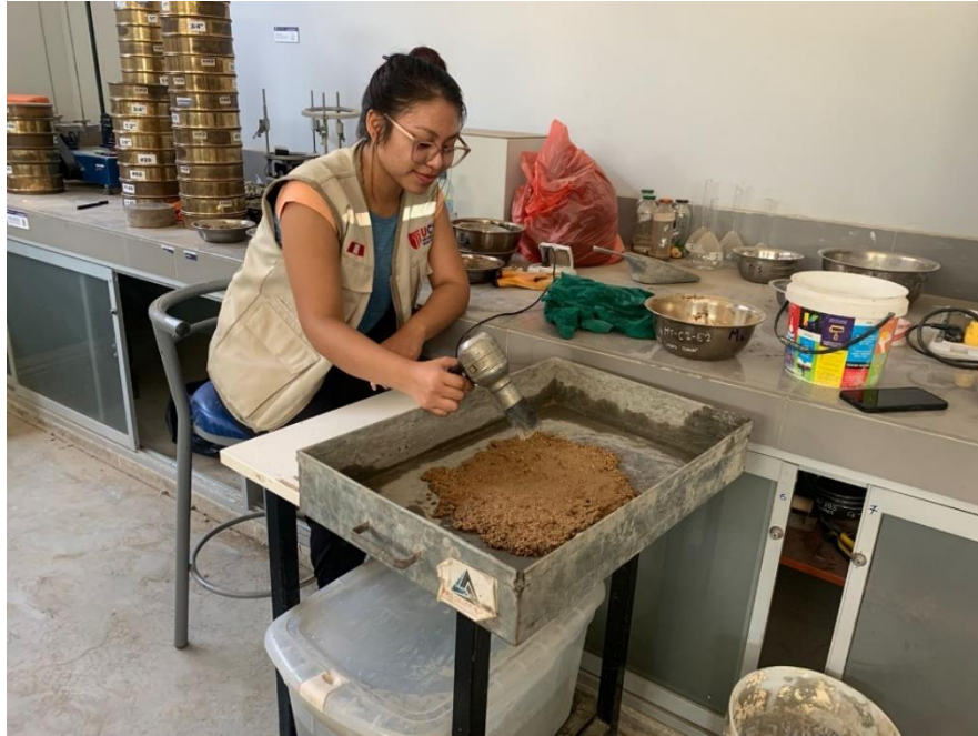
Figura 24. Ensayo de absorción de agregado fino
