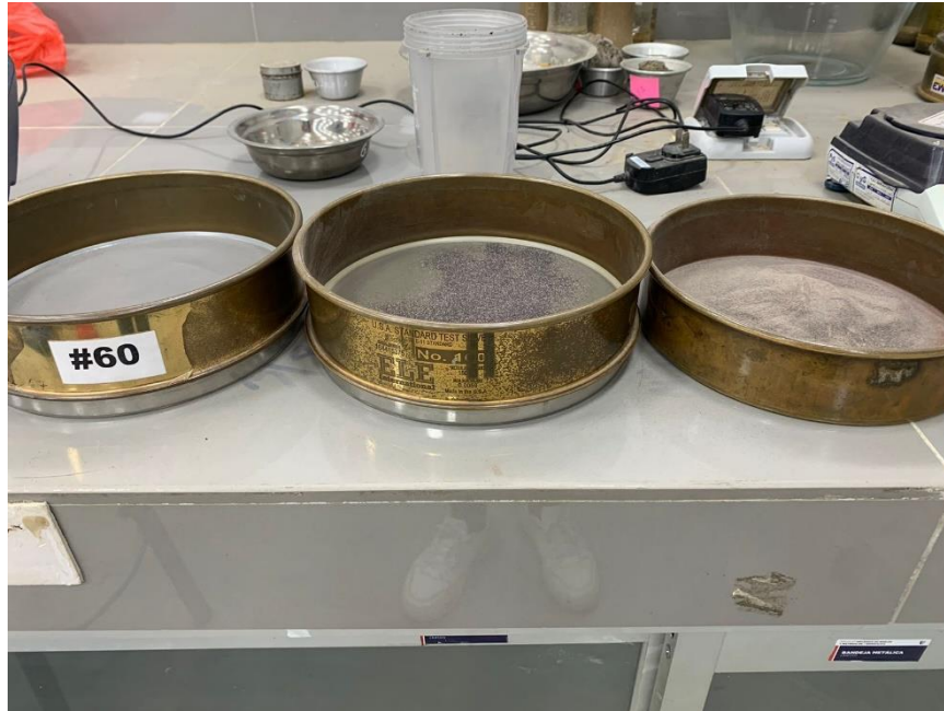
Figura 26. Ensayo de finura del polvo alga marina pasando por la malla N°100
