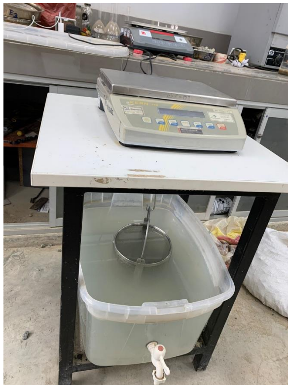
Figura 23. Ensayo de absorción de agregado grueso
