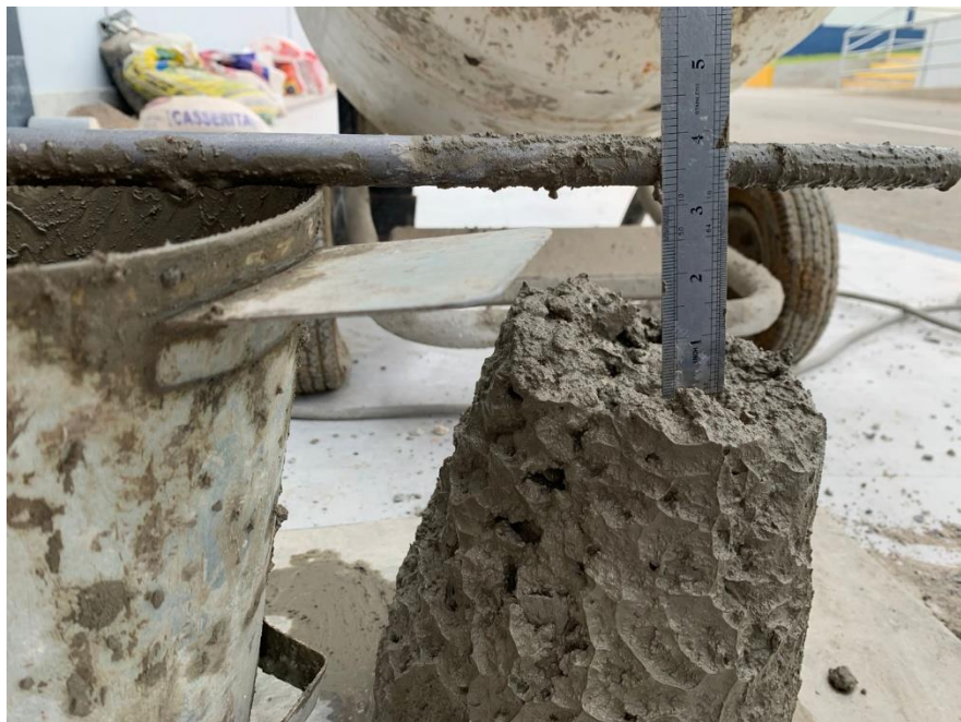
Figura 25. Prueba de Slump en mezcla patrón
