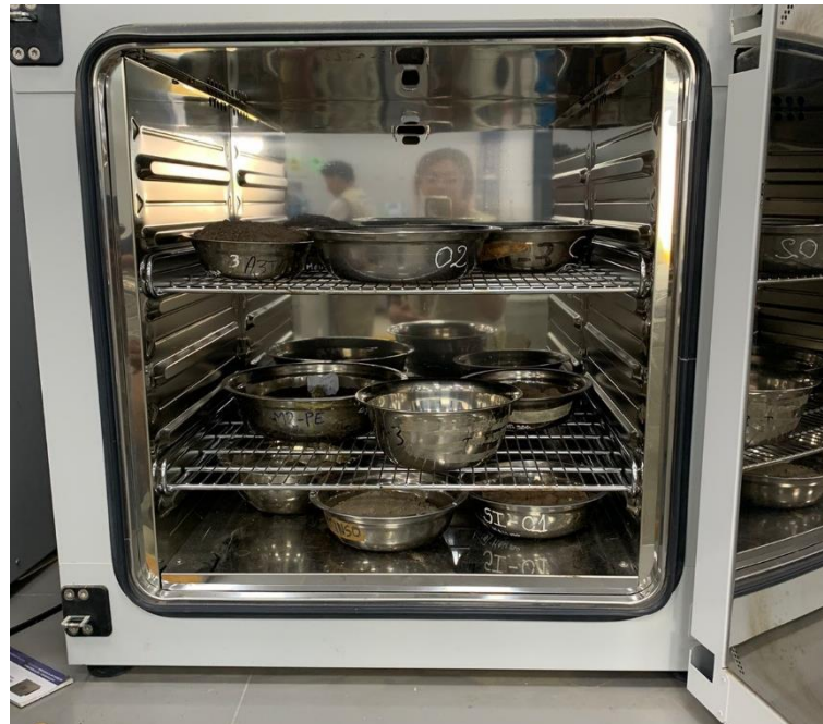
Figura 21. Ensayo de contenido de humedad de agregado fino y grueso
