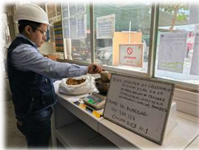
Figura 8. Muestras tomadas de Calicata N°02, Progresiva Km 1+000
