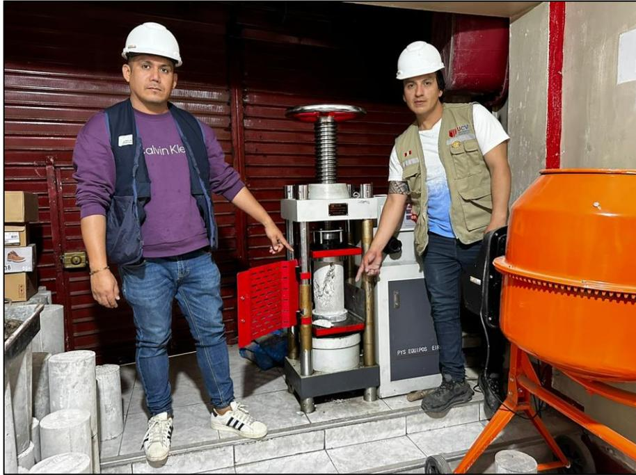
IMAGEN N° 3 Rotura de probetas al 7%, 15% y 25%
