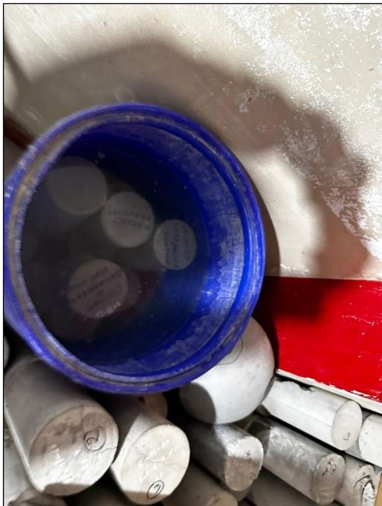
IMAGEN N° 4 Curado de probetas
