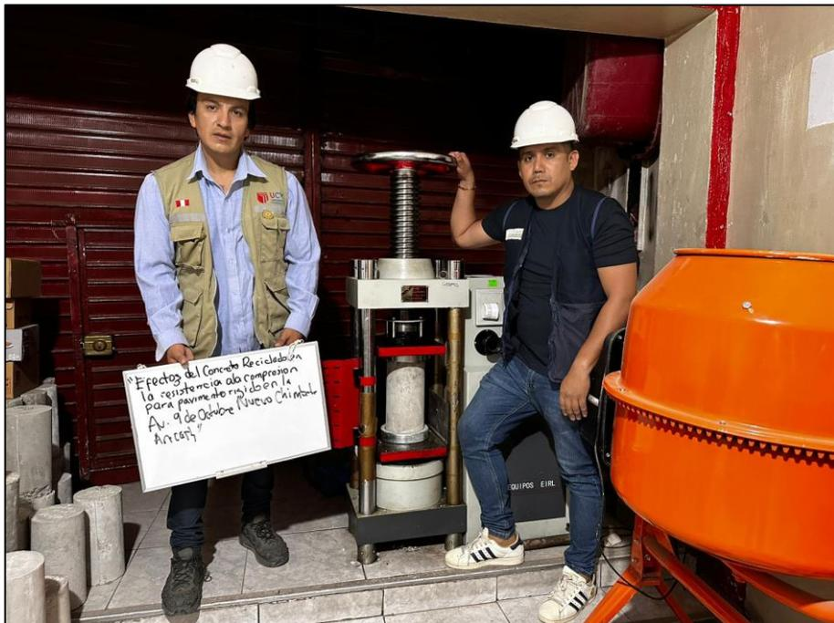
IMAGEN N° 2 Rotura de probetas patrón
