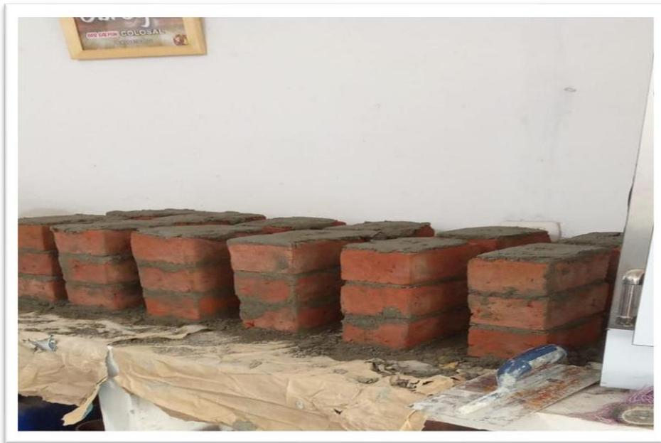
***Foto: unidad de albañilería para ensayo de resistencia a la compresión axial laboratorio de suelos y pavimentos CJK SAC.***
