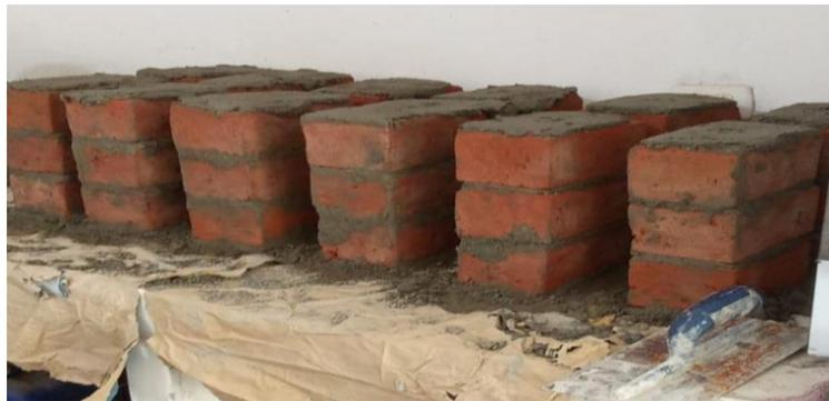
Foto: unidad de albañilería en pilas
