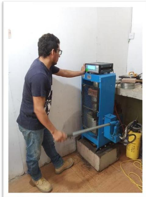
**Fotos: Rotura de la unidad de albañilería-laboratorio de suelos y pavimentos CJK SAC.**
