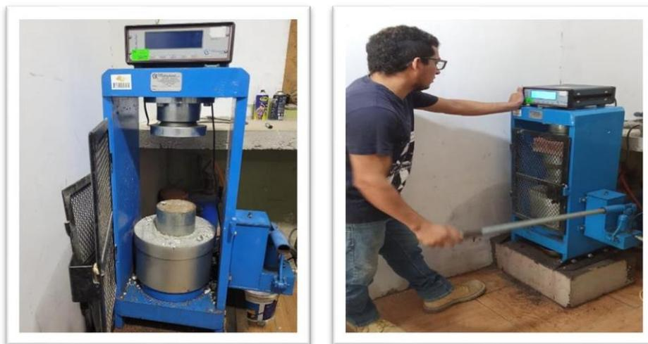
Foto: Prensa Hidráulica Para Realización De Ensayos De Compresión- Laboratorio De Suelos Y Pavimentos CJK SAC
