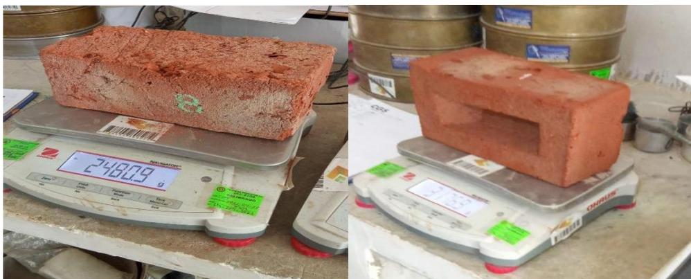
Foto: Peso de las unidades de albañilería después de ser retirados del agua
