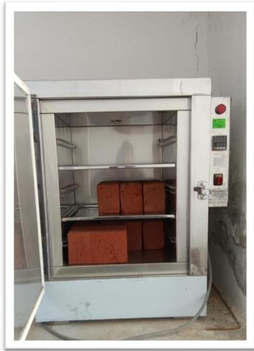
***Foto: prueba de absorción-laboratorio de suelos y pavimentos CJK SAC.***
