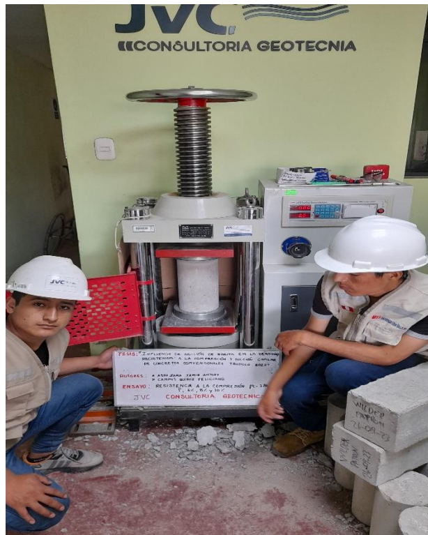
Figura 25: Rotura de las probetas cilíndricas.
