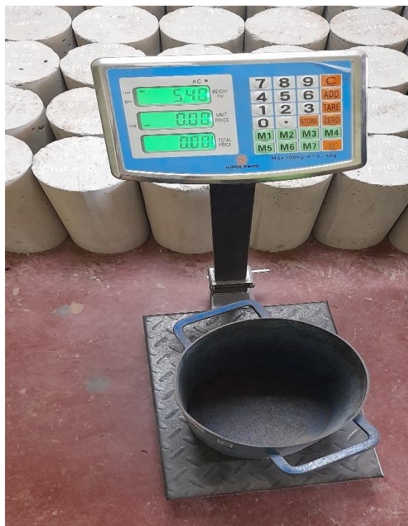
Figura 21: Enrasado de los agregados fino y grueso para los ensayos pesos unitarios y vacío.
