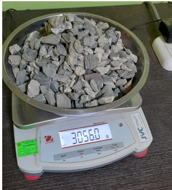
Figura 22: Ensayo del análisis granulométrico.
