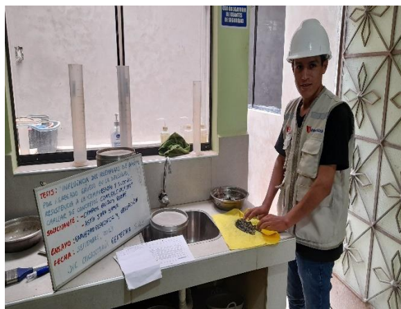
Figura 23: Gravedad específica y absorción de los agregados.
