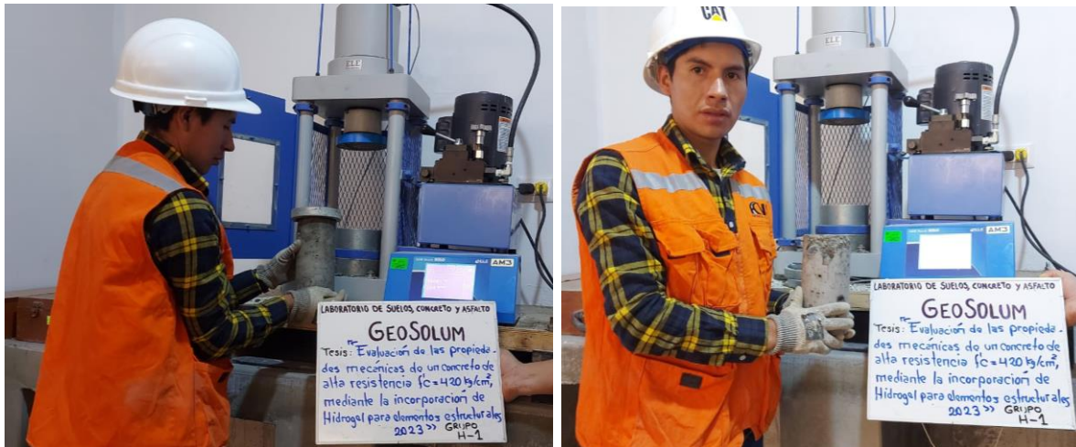
Ejecución del ensayo de resistencia a la compresión haciendo uso de la prensa de compresión, previa calibración de la máquina.
