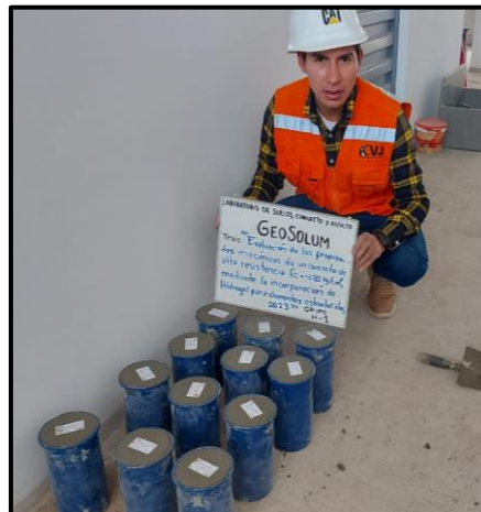
Figura 23. Elaboración de especímenes cilíndricos
