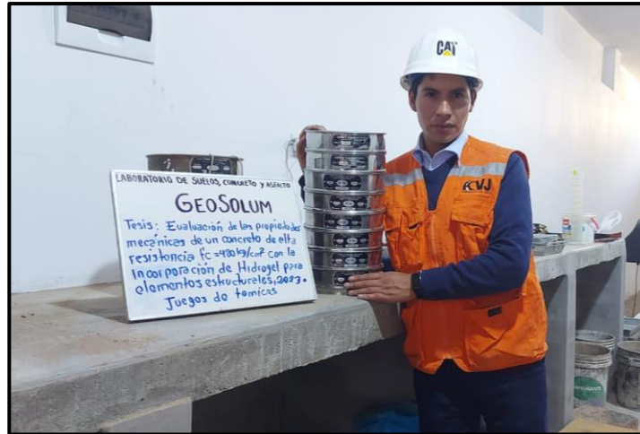
Figura 17. Ejecución del ensayo de análisis granulométrico para agregado fino
