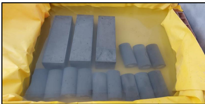
Figura 25. Poza de curado con las muestras del grupo patrón
