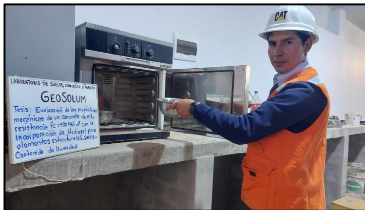
Figura 19. Ejecución del ensayo de contenido de humedad
