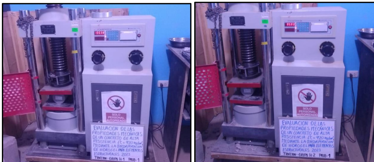
Figura 29. Ejecución del ensayo de resistencia a la tracción
