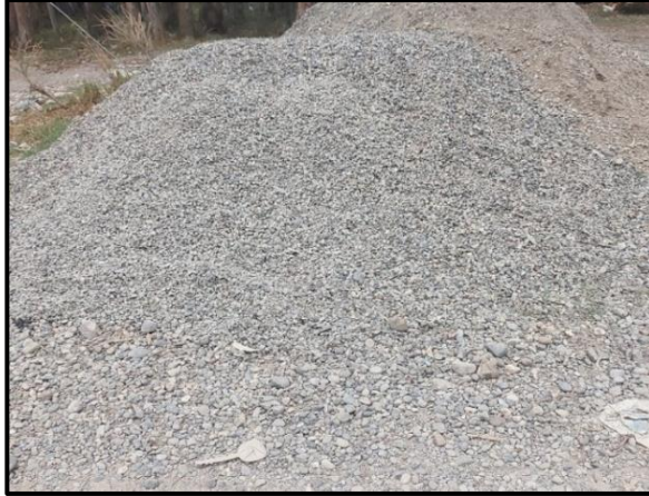
Figura 14. Montículo de agregado grueso
