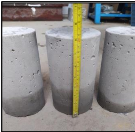
Figura 26. Medición de especímenes cilíndricos
