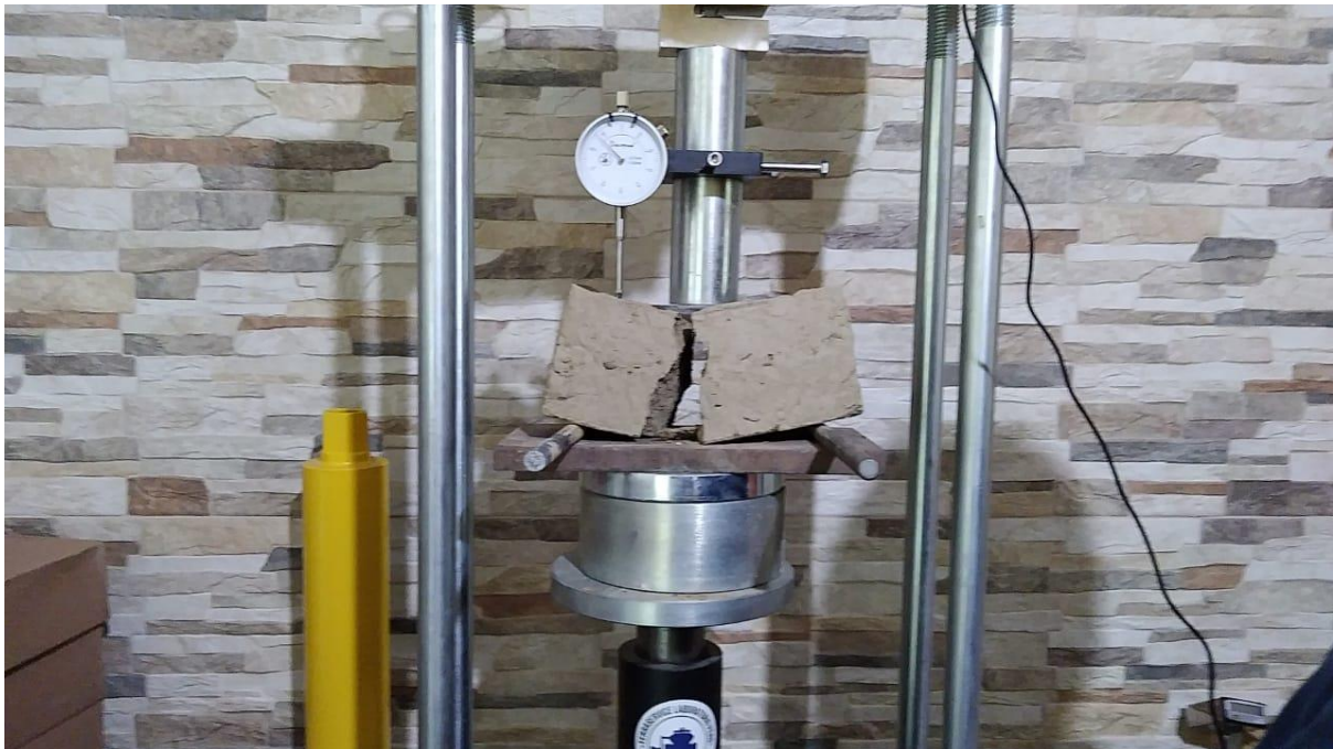
Figura 15 Falla de la muestra al ensayo de resistencia a flexión
