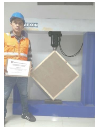
Figura 24. Ensayo a compresión diagonal.
