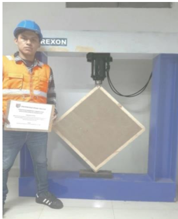
Figura 39. Ensayo a compresión diagonal de los paneles quincha y totora.
