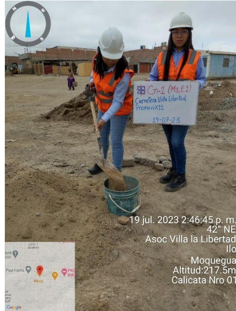
Fotografía 6. Extracción de la muestra de la calicata 1.
