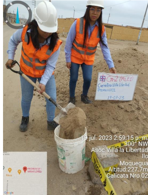
Fotografía 10. Extracción de la muestra de la calicata 2.
