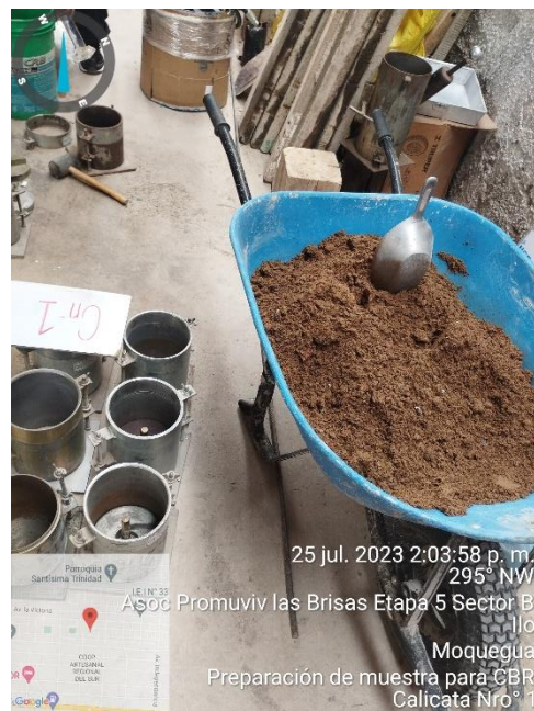
Fotografía 32. Mezclado de las muestras.
