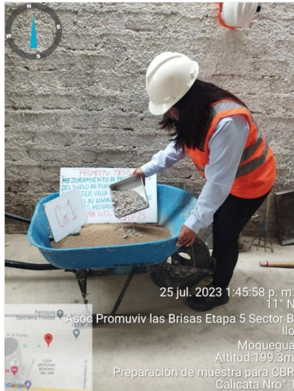
Figura 50. Incorporación de Residuo de Concreto a la muestra.
