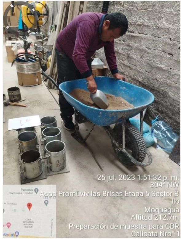
Figura 45. Incorporación de la muestra con Residuos de Concreto.
