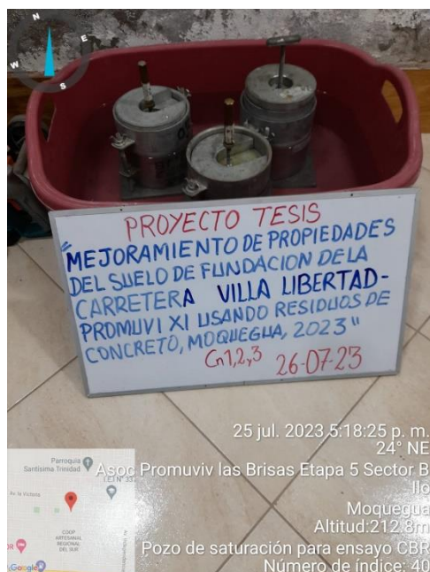
Fotografía 39. Muestra sumergido en agua por tres días.
