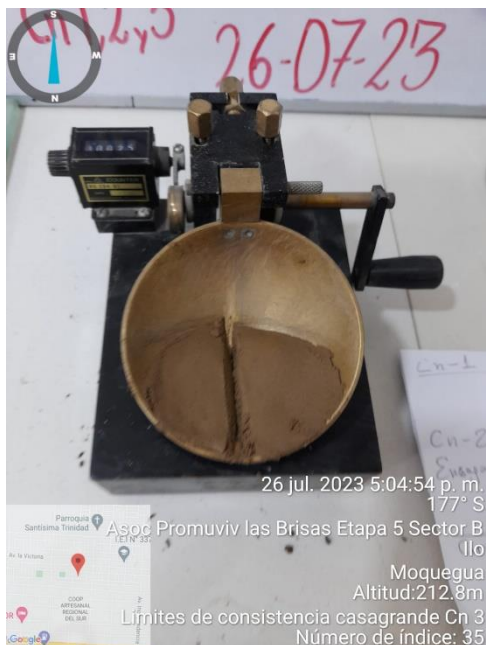
Fotografía 41. Ensayo de Limite Líquido.
