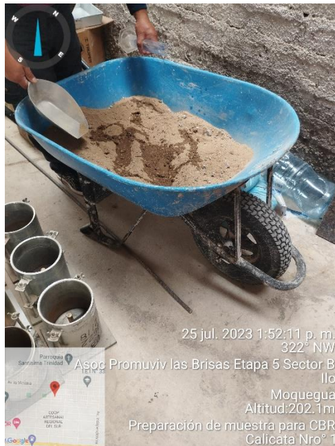
Fotografía 31. Incorporación de agua en las muestras.
