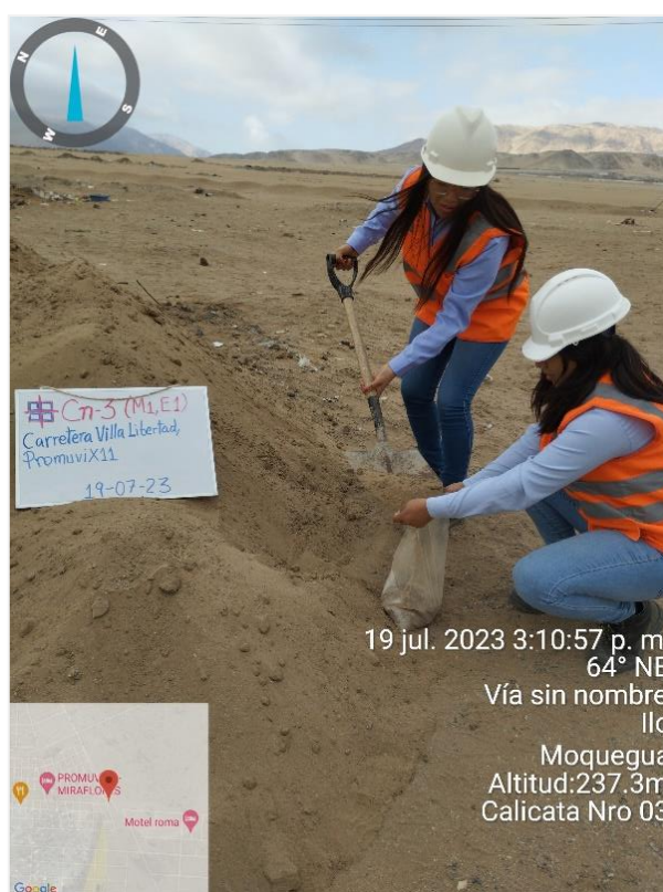
Figura 10. Extracción de la Muestra del Suelo.
