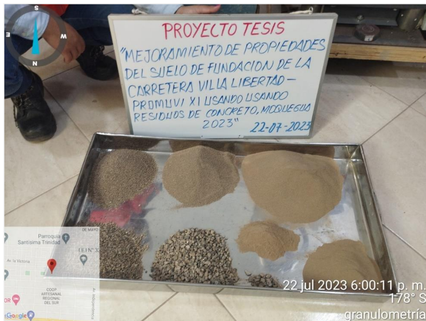
Figura 22. Granulometría de la muestra patrón.
