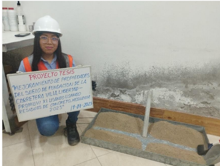
Figura 12. Cuarteo de las Muestras de las Calicatas 1, 2 y 3.
