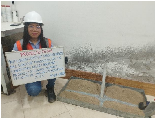
Fotografía 17. Cuarteo de las muestras de las Calicatas 1,2 y 3.
