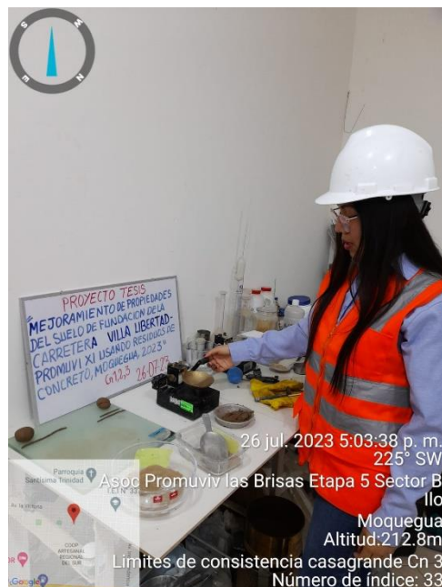
Fotografía 42. Utilización de la Cuchara de Casagrande.
