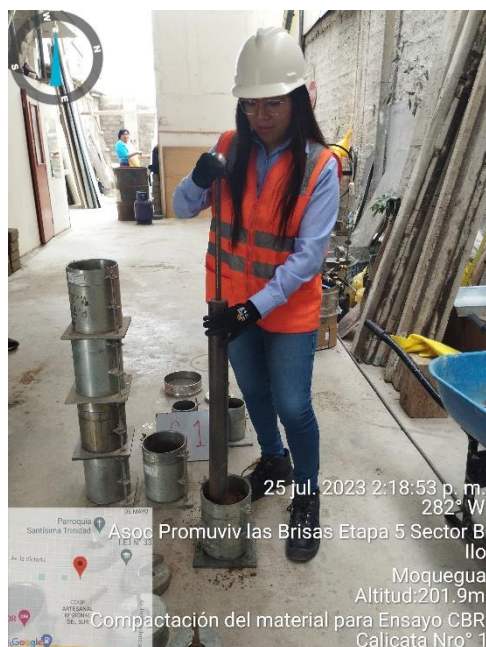
Fotografía 35. Ensayo de Compactación Proctor.
