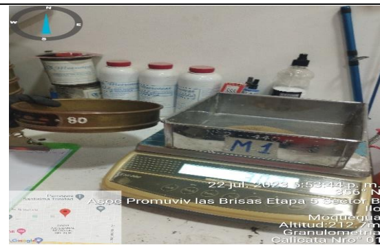
Fotografía 22. Peso de la muestra patrón para la Granulometría.
