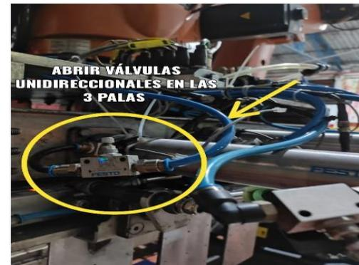
ABRIR VÁLVULAS UNIDIRECCIONALES EN LAS 3 PALAS
