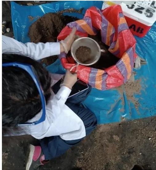
**Figura 6.** Tamizado de la muestra de suelo
