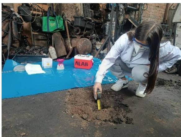
**Figura 5.** Medición de profundidad para obtención de la muestra.
