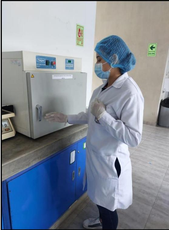
Se realizó el secado de la cascarilla de arroz para seguidamente ser triturada y obtener una materia en polvo.
