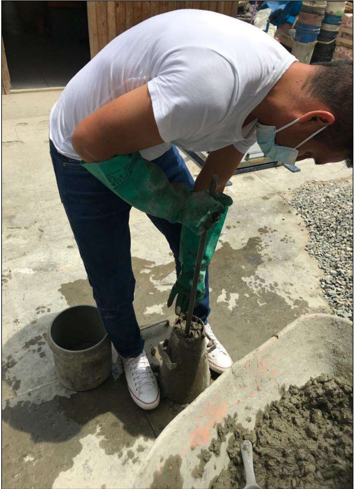
Realización del ensayo de asentamiento
