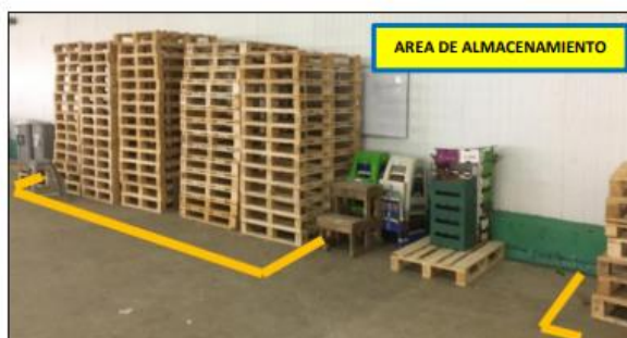
Figura 24. Delimitación y rotulación del almacenamiento de pallets
