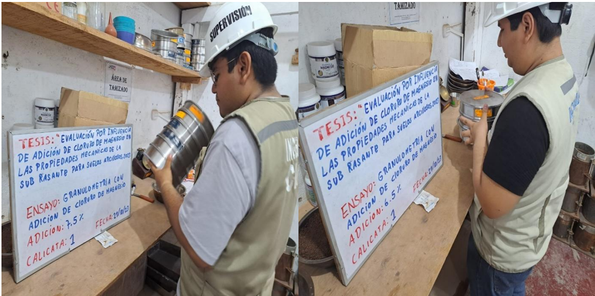
En las imágenes podemos observar a los tesistas realizar el ensayo de análisis granulométrico del material con adición de cloruro de magnesio
