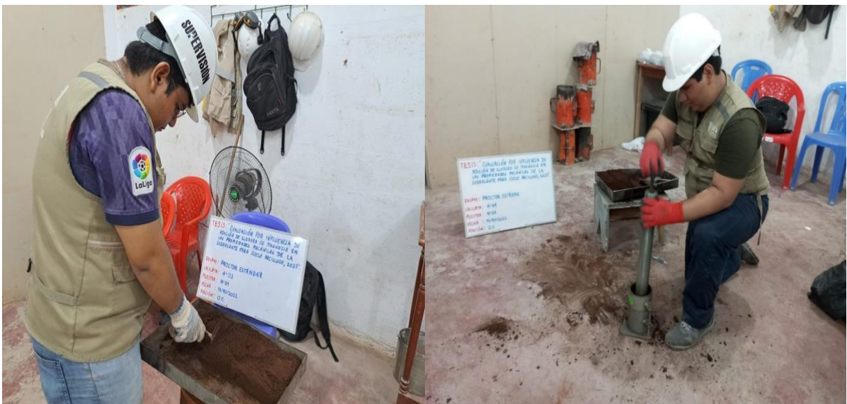
En las imágenes podemos observar a los tesistas realizar en ensayo de Proctor estándar con pistón de 7 libras del material de terreno de fundación.
