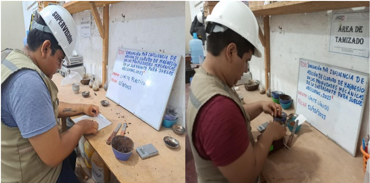
En las imágenes podemos observar al personal técnico realizando ensayo de Límites de Atterberg del material de terreno de fundación.
