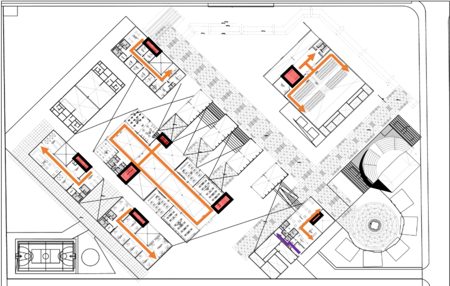
**Figura 82** Sistema de circulación de Segundo Nivel
