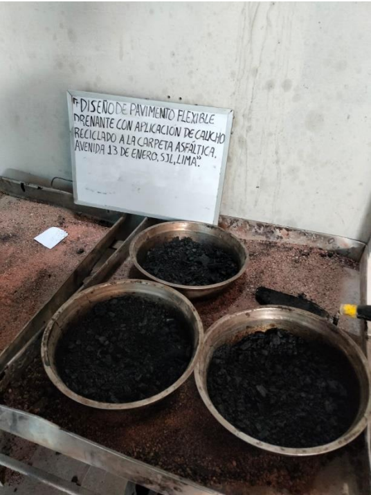
Combinación de arena, grava y cemento asfáltico en una cocina a 150° gr.
