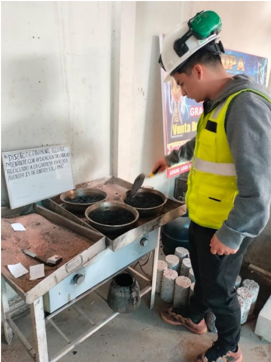
Combinación de arena, grava y cemento asfáltico en una cocina a 150° gr.
