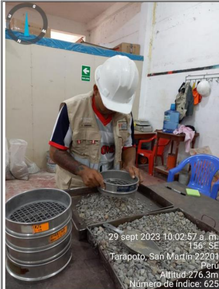
Fotos nº 05-06: En las imágenes se puede apreciar el ensayo de análisis granulométricos de los agregados.
