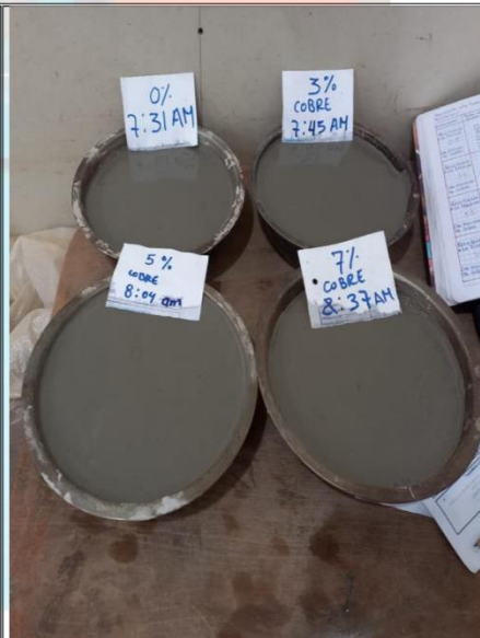
Fotos nº 27-28: En las imágenes podemos observar el ensayo de tiempo de fraguado.
