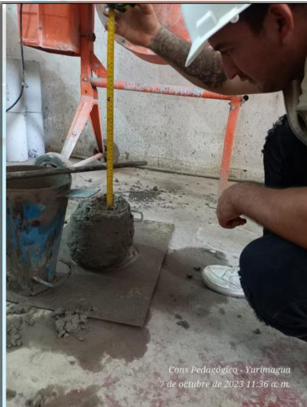
Fotos nº 19-20: En las imágenes podemos observar al personal realizando la prueba de asentamiento para los diseños de Mezclas.
