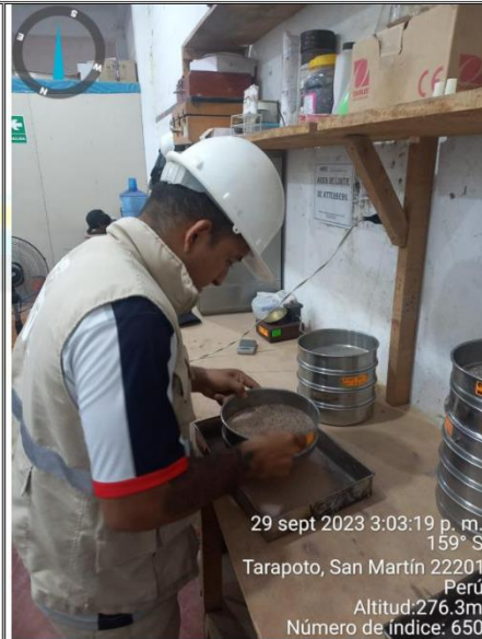
Fotos nº 05-06: En las imágenes se puede apreciar el ensayo de análisis granulométricos de los agregados.
