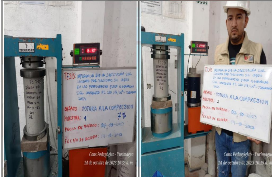
Fotos n° 31-32: En las imágenes podemos observar la resistencia a la compresión axial de los testigos de concreto
