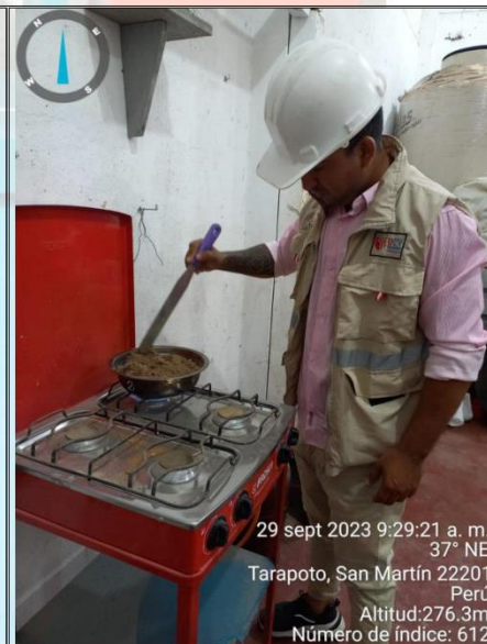
Fotos nº 07-08: En las imágenes se puede apreciar el ensayo el lavado y secado en estufa de agregado fino.
