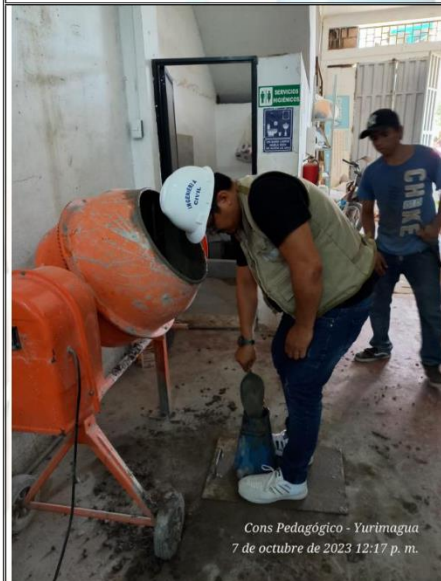
Fotos nº 19-20: En las imágenes podemos observar al personal realizando la prueba de asentamiento para los diseños de Mezclas.
