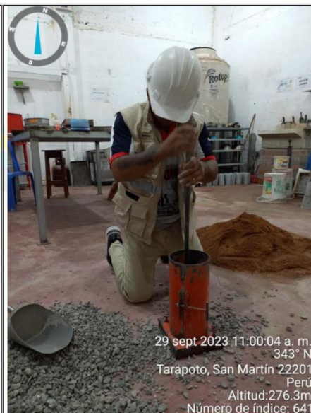
Fotos nº 09-10: En las imágenes podemos observar realización del ensayo de peso unitario de la grava.
