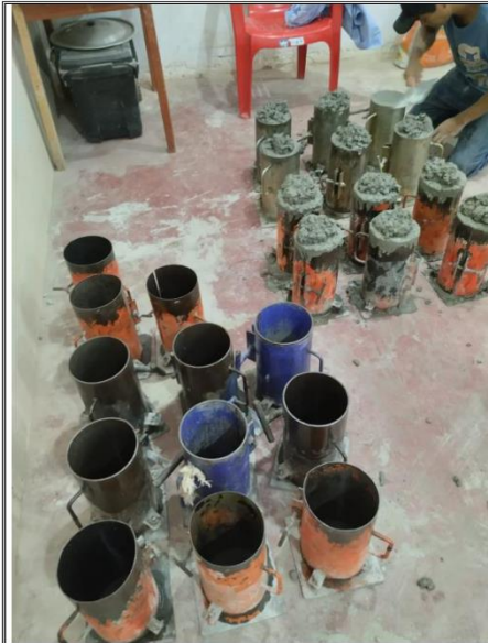
Fotos nº 25-26: En las imágenes podemos observar el moldeo de los testigos de concreto.
