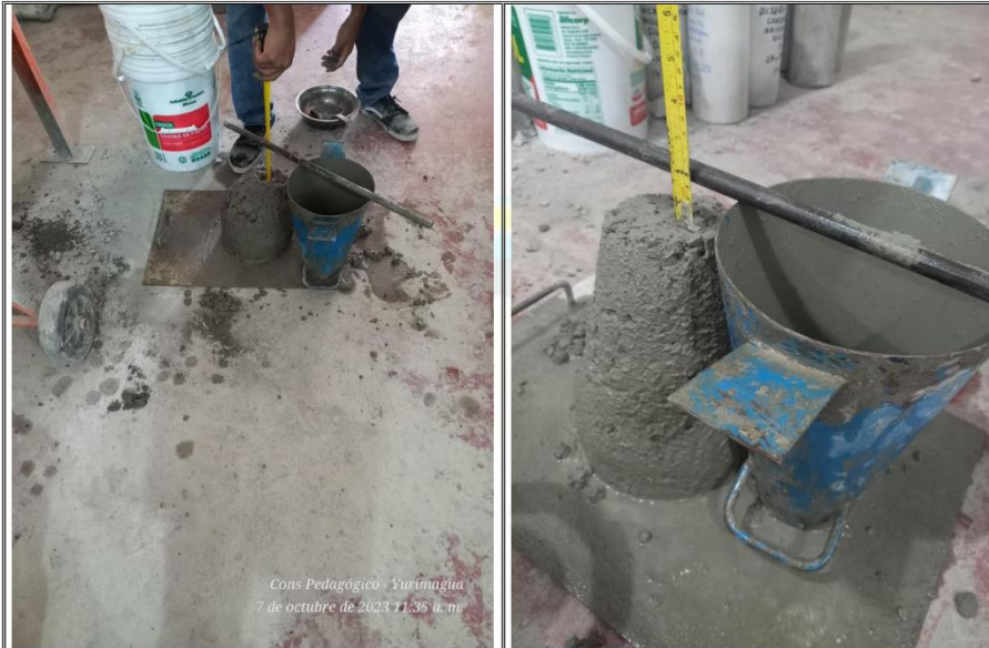
Fotos nº 21-22: En las imágenes podemos observar al personal realizando la prueba de asentamiento para los diseños de Mezclas.
