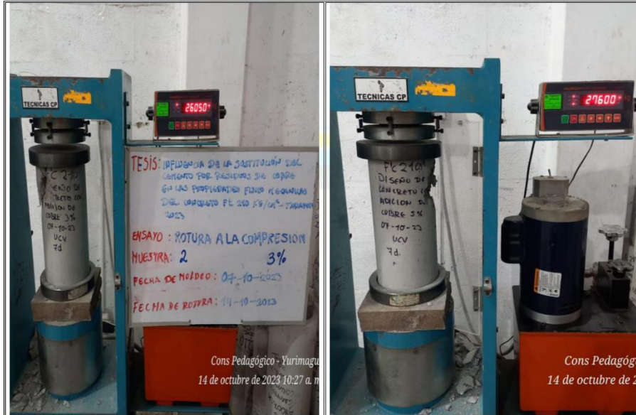
Fotos n° 29-30: En las imágenes podemos observar la resistencia a la compresión axial de los testigos de concreto
