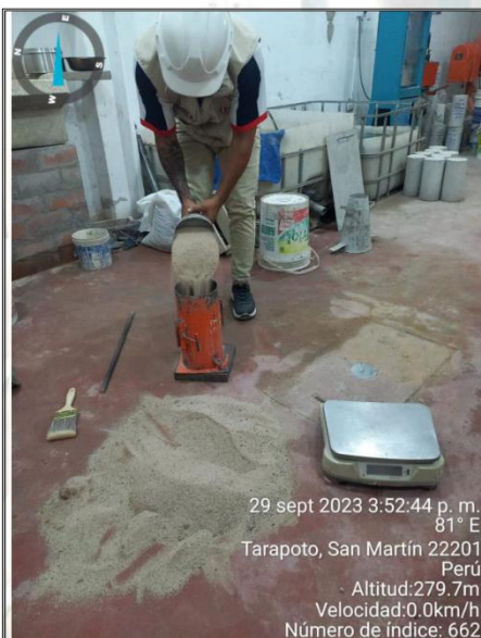
Fotos nº 11-12: En las imágenes podemos observar realización del ensayo de peso unitario de la arena zarandeada.
