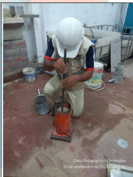
Fotos nº 11-12: En las imágenes podemos observar realización del ensayo de peso unitario de la arena zarandeada.
