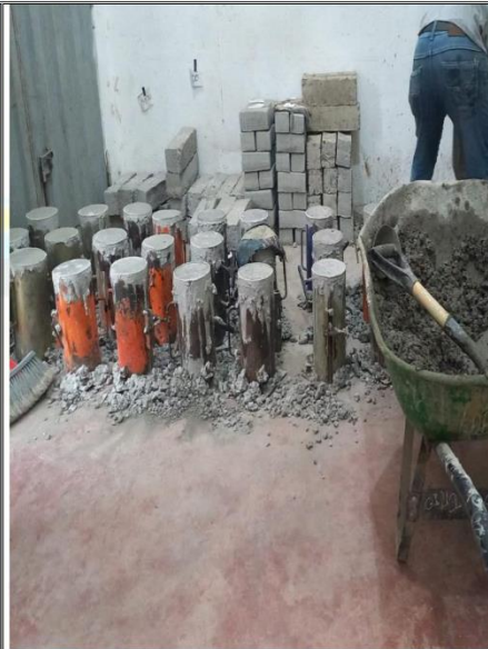
Fotos nº 25-26: En las imágenes podemos observar el moldeo de los testigos de concreto.
