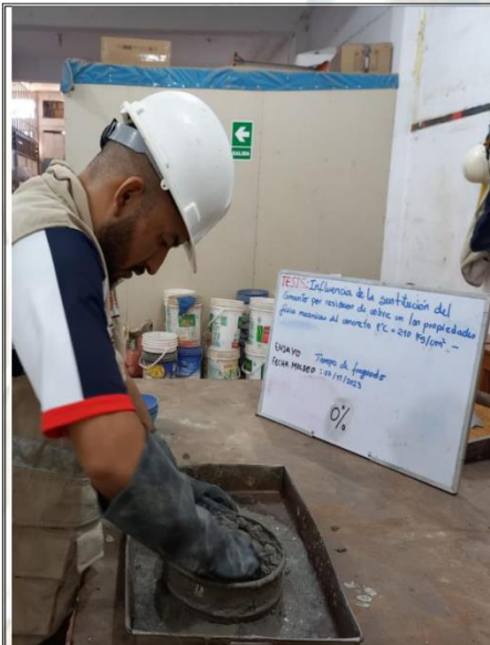
Fotos nº 27-28: En las imágenes podemos observar el ensayo de tiempo de fraguado.
