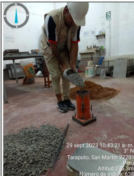
Fotos nº 09-10: En las imágenes podemos observar realización del ensayo de peso unitario de la grava.
