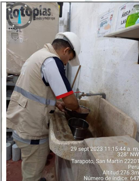
Fotos nº 07-08: En las imágenes se puede apreciar el ensayo el lavado y secado en estufa de agregado fino.
