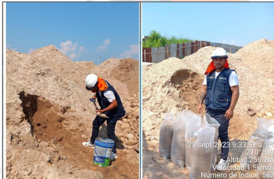
Fotos nº 03-04: En las imágenes se puede apreciar el muestreo de la arena zarandeada.
