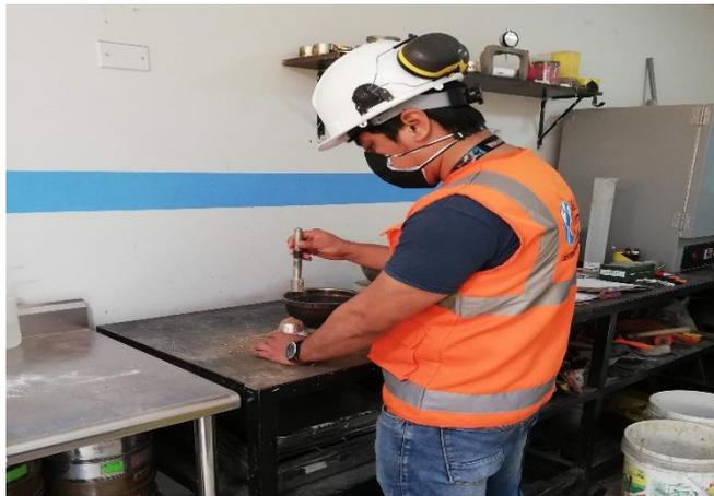
**Figura 12.** Determinación de la condición SSS.
