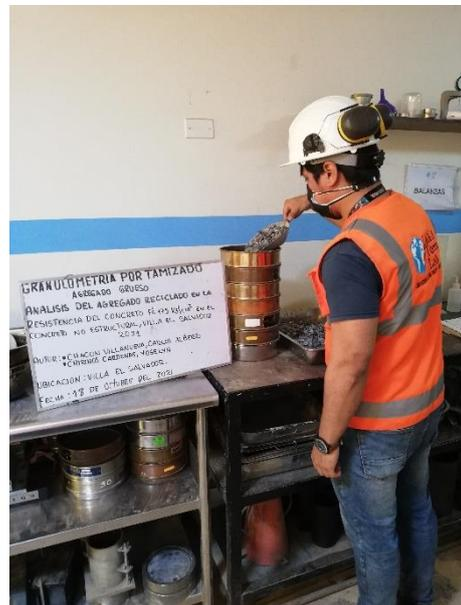
Análisis granulométrico del agregado
