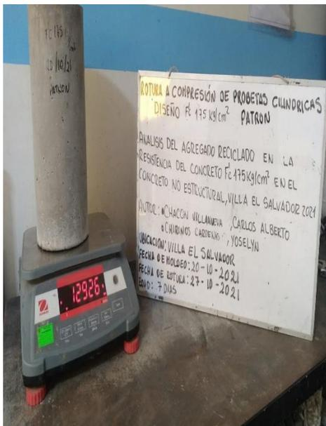
Peso de la probeta cilíndrica para el ensayo de la resistencia a la compresión a los 7 días, diseño patrón
