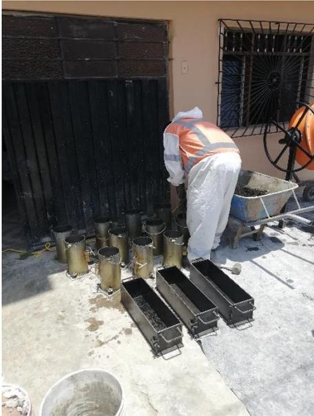
Mezcla para las probetas cilíndricas
