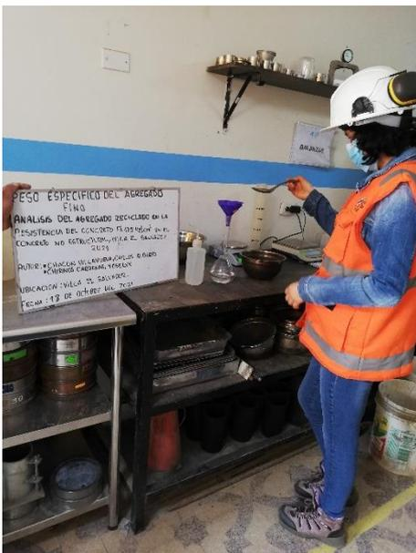
Porcentaje de absorción y peso específico de agregado fino
