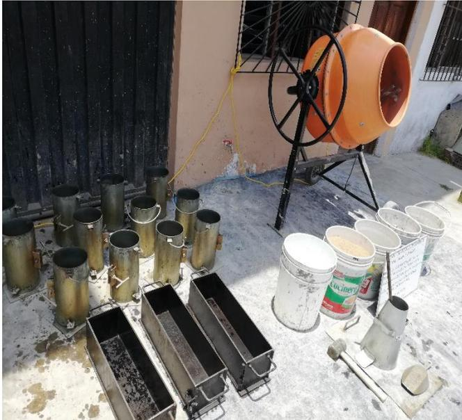
Moldes cilíndricos y prismáticos
