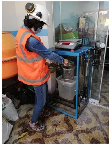
Porcentaje de absorción y peso específico del agregado grueso
