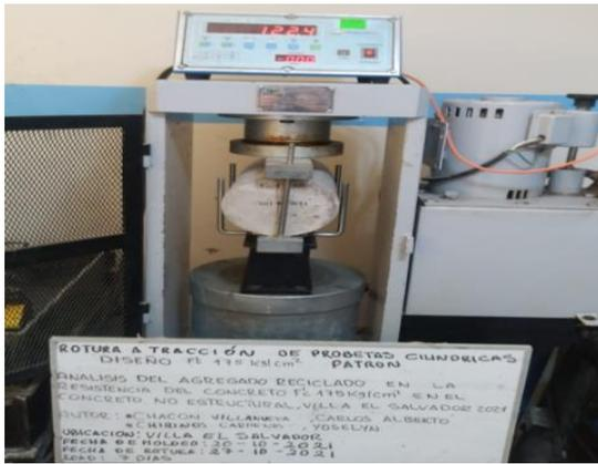
**Figura 21.** Ensayo de la resistencia a la tracción por compresión diametral en probetas, diseño patrón a los 7 días
