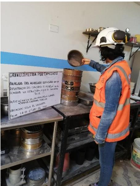
Análisis granulométrico del agregado
