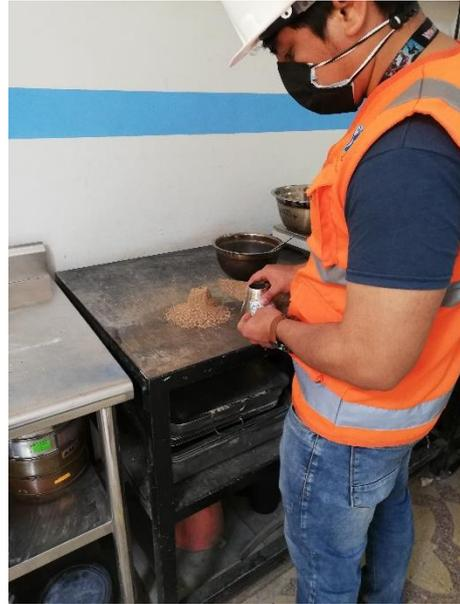
Retiro del cono para determinar la condición SSS
