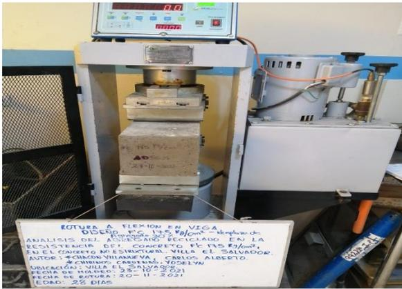
**Figura 18.** Ensayo de la resistencia a la flexión, reemplazo del 30% a los 28 días
