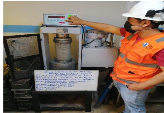
**Figura 15.** Ensayo de la res. a la compresión en probetas, reemplazo del 30% a los 28 días
