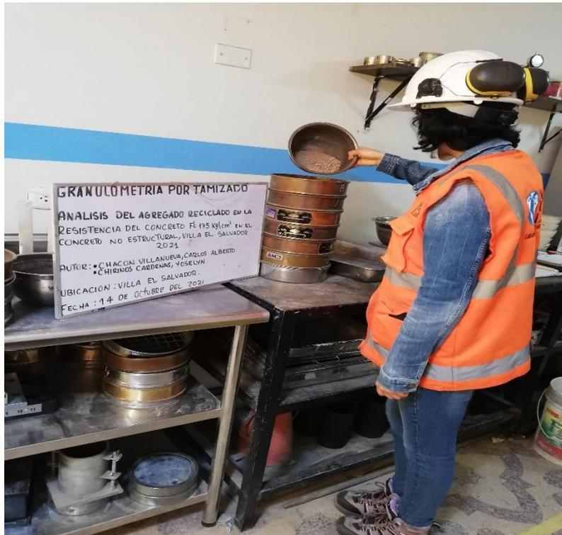
**Figura 8.** Ensayo de análisis granulométrico del agregado fino
