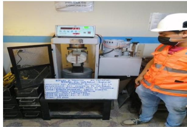
**Figura 22.** Ensayo de la resistencia a la tracción por compresión diametral en probetas, reemplazo del 30% a los 28 días
