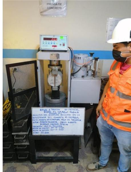
Ensayo de la resistencia a la tracción por compresión diametral a los 28 días, reemplazo de 20%
