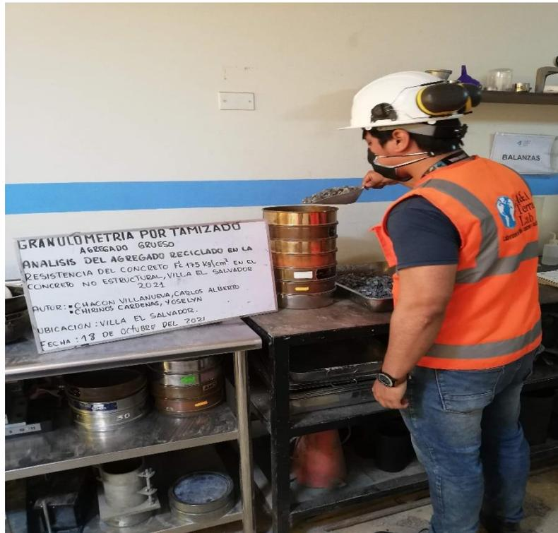
**Figura 10.** Ensayo de análisis granulométrico del agregado grueso
