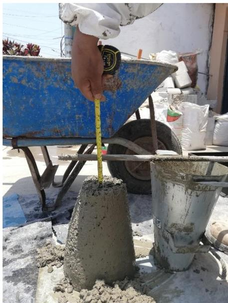
Slump del concreto patrón
