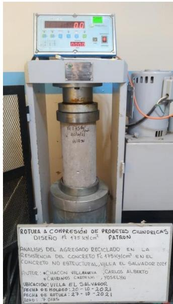
Ensayo de la resistencia a la compresión a los 7 días, diseño patrón
