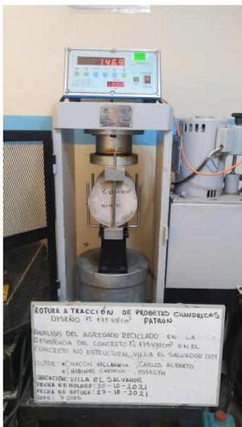
Ensayo de la resistencia a la tracción por compresión diametral a los 7 días, diseño patrón
