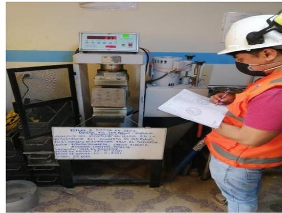
**Figura 19.** Toma de datos del ensayo de la resistencia a la flexión
