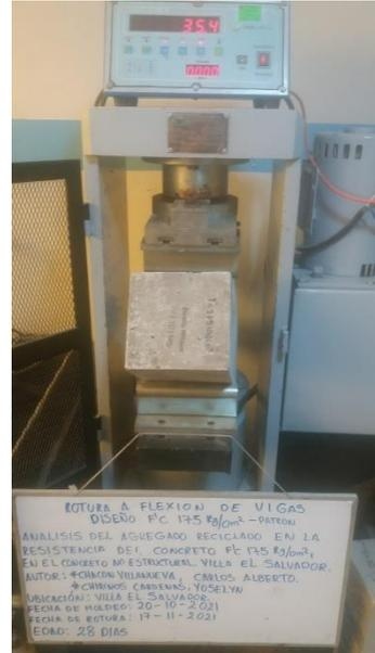
Ensayo de la resistencia a la flexión a los 28 días, reemplazo de 30%      Rotura a flexión a los 28 días, diseño patrón
