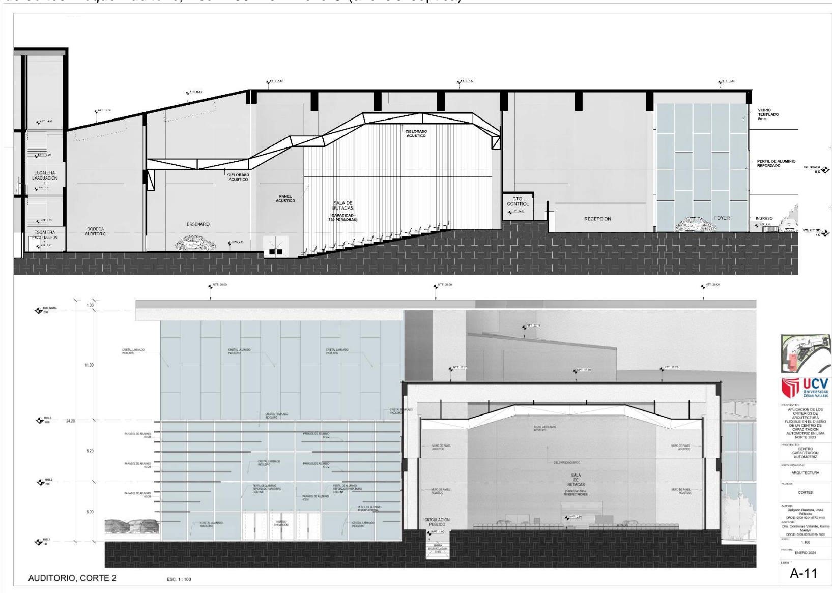
Figura 41 Plano de cortes Bloque Auditorio, Esc1:100. Ver Anexo O (análisis isóptica)
