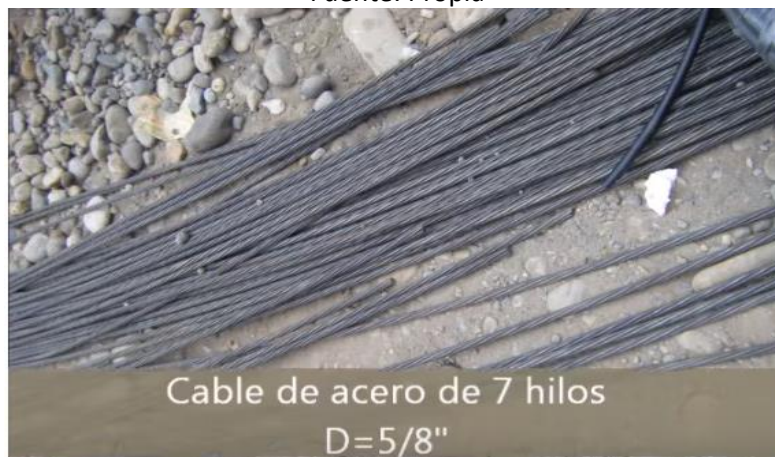
Figura 24. Cable de acero de 7 hilos D=5/8"
