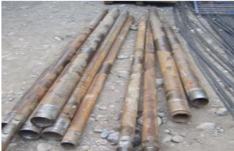
Figura 20. Tubería para casing
