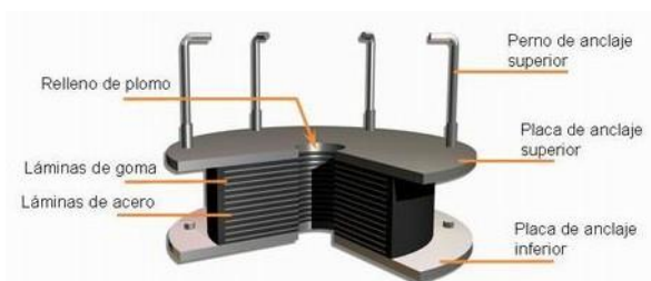
Figura 1.3.4.1.4. Esquema del aislador LRB
