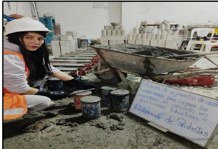
Figura 14. Vaciado y curado
