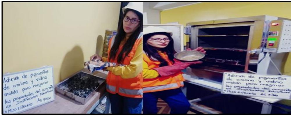
Figura 6. Absorción y gravedad específica del agregado fino
