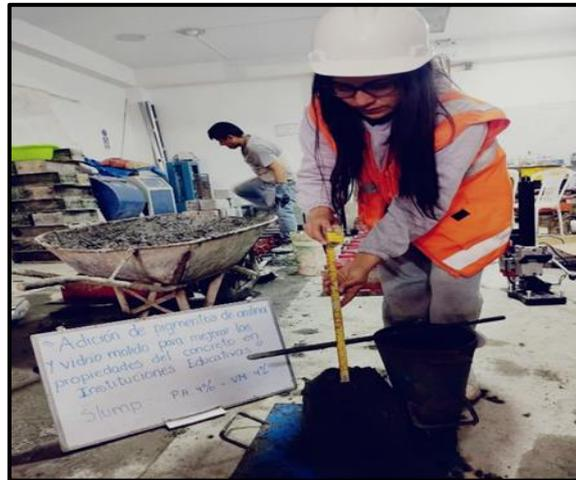
Figura 12. Asentamiento del concreto
