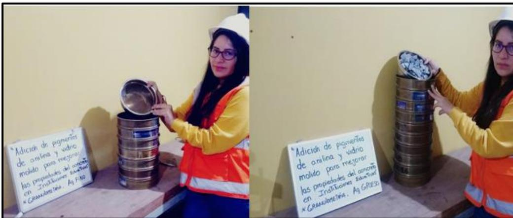
Figura 5. Granulometría de agregados
