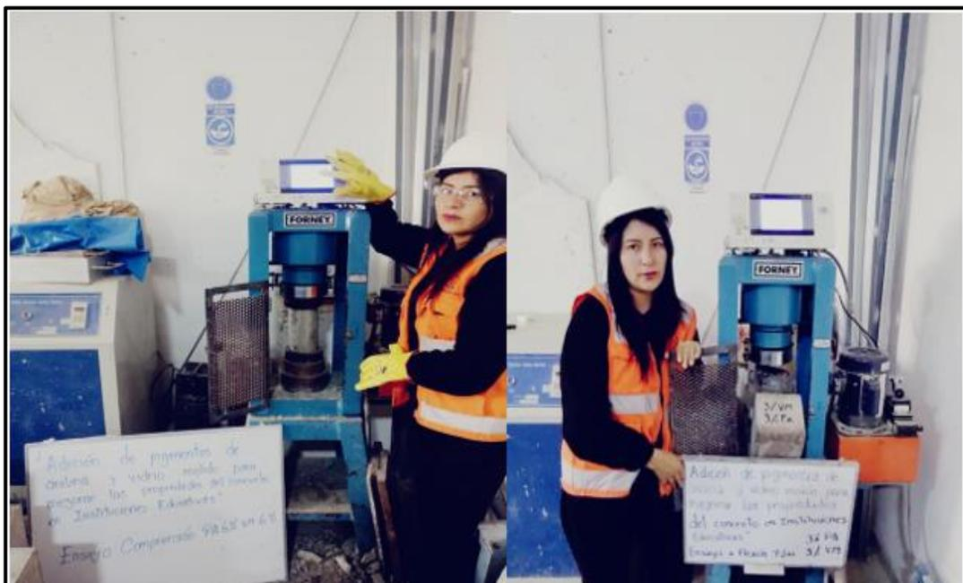
Figura 15. Ensayos de esfuerzo a la compresión y flexión
