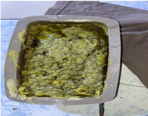
*Ilustración 4. Mezcla poco compacta*
