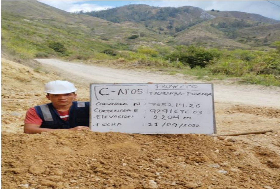
Imagen 3 : Tacabamba, escabacion y estracion de muestra de las calicatas C-5,C-6 Y C-7 , Septiembre 2022
