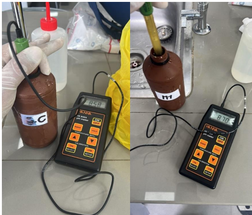
pH-metro utilizado para analizar las muestras
