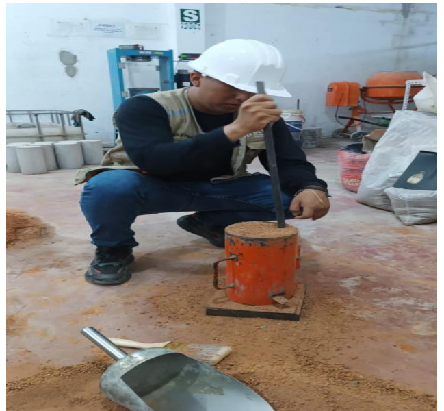
Foto N° 11 y N° 12: En las imágenes podemos observar la realización del ensayo de peso unitario.
