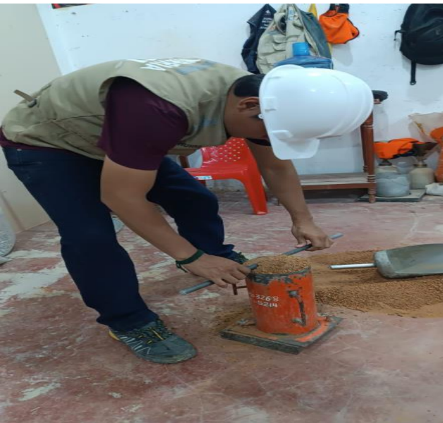
Foto N° 11 y N° 12: En las imágenes podemos observar la realización del ensayo de peso unitario.
