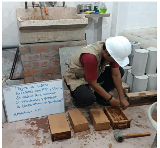
Foto N° 07 y N° 08: En las imágenes podemos observar realizando el moldeo de los diseños de mezcla par el ladrillo.
