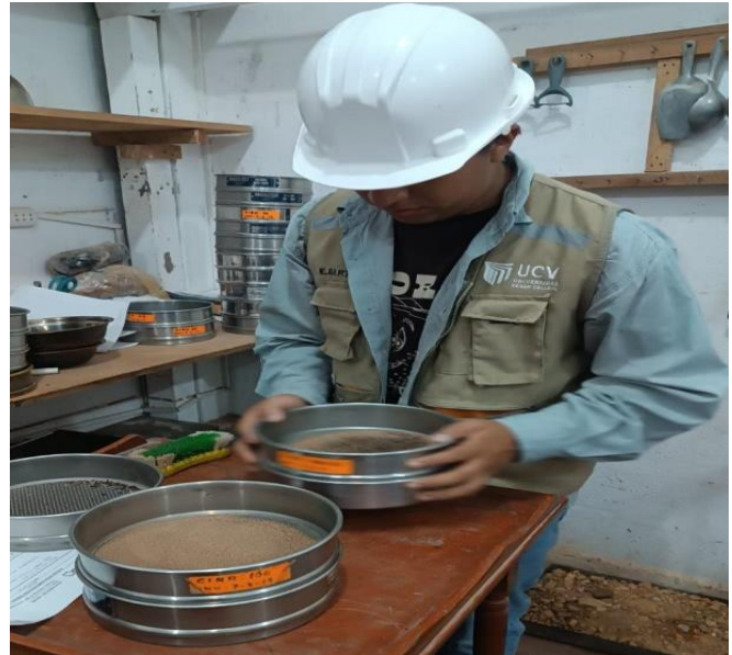
Foto N° 03 y N° 04: En las imágenes se puede apreciar realizando ensayos de análisis granulométrico de los materiales.
