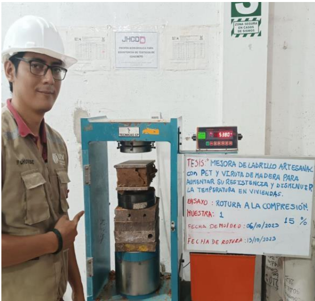
Foto N° 13 y N° 14: En las imágenes podemos observar la realización de rotura del diseño de mezcla del ladrillo artesanal.
