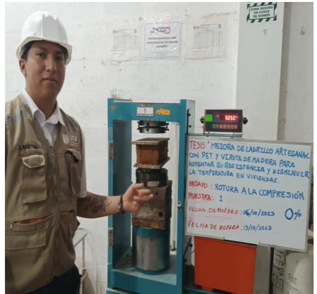
Foto N° 13 y N° 14: En las imágenes podemos observar la realización de rotura del diseño de mezcla del ladrillo artesanal.
