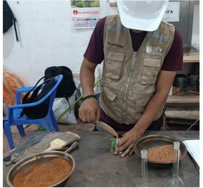
Foto N° 09 y N° 10: En las imágenes podemos observar el ensayo de gravedad específica.
