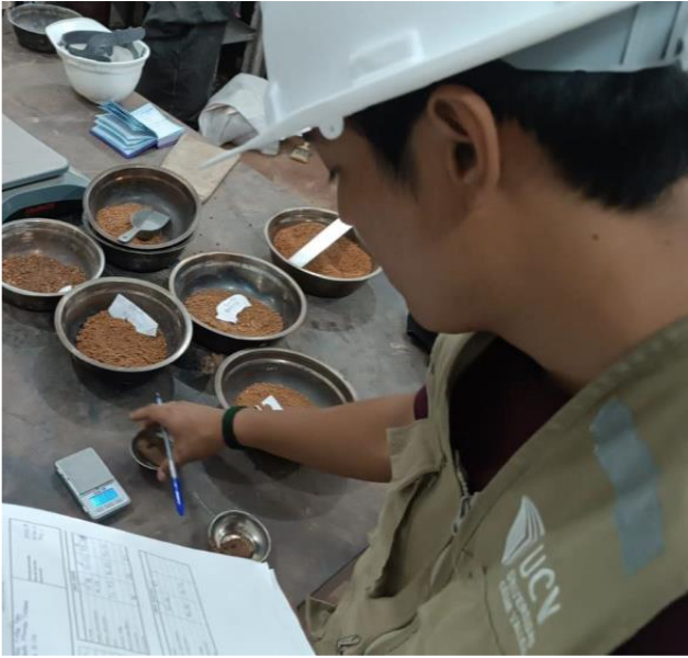
Foto N° 05 y N° 06: En las imágenes podemos observar realizando ensayo de humedad.
