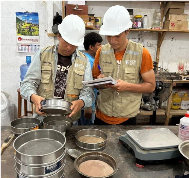
Foto N° 03 y N° 04: En las imágenes se puede apreciar realizando ensayos de análisis granulométrico de los materiales.
