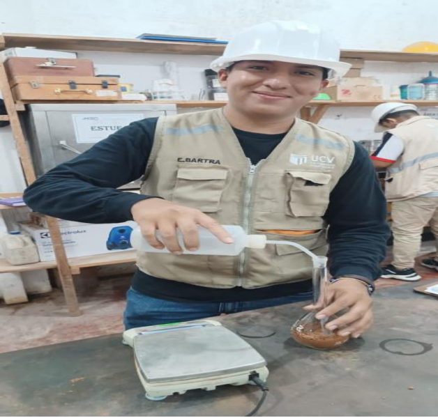
Foto N° 09 y N° 10: En las imágenes podemos observar el ensayo de gravedad específica.
