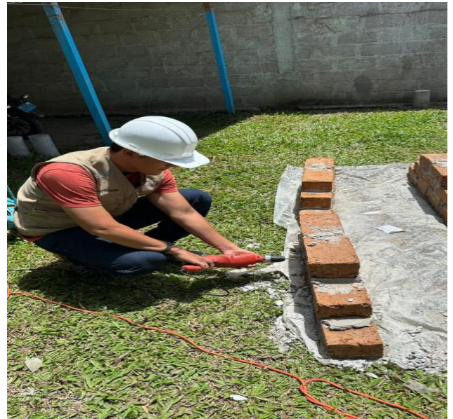
Foto N° 15 y N° 16: En las imágenes podemos observar la realización del ensayo de temperatura.
